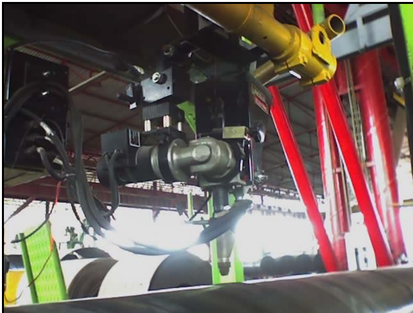
Figura 3.13 Se observa el cabezal de soldadura de la maquina formadora E en donde se puede apreciar
