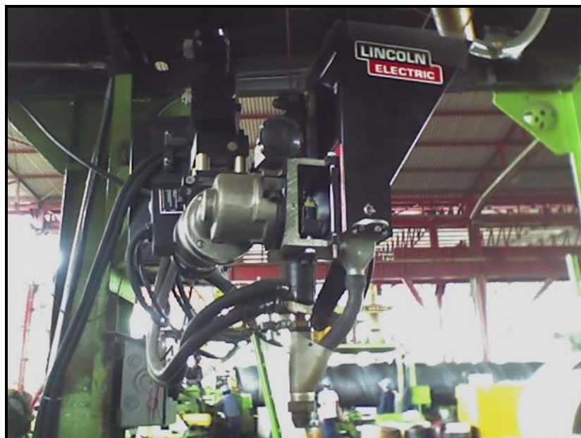
Figura 3.12 Vista frontal del cabezal de soldadura de la formadora E. Nótese que la misma maquina posee sus mecanismos de avance y movilidad
