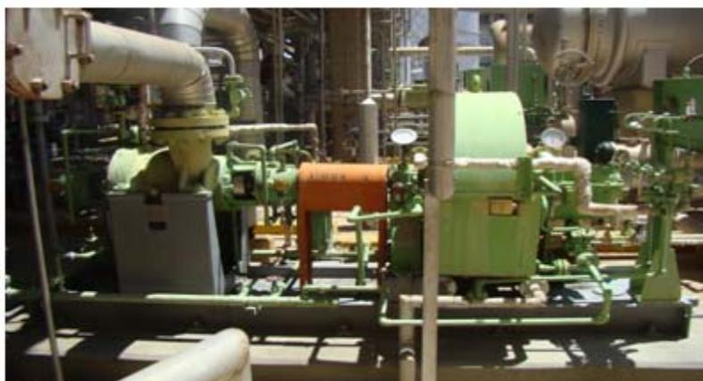
Figura 4.7. Bomba Centrifuga multietapas P-624A
