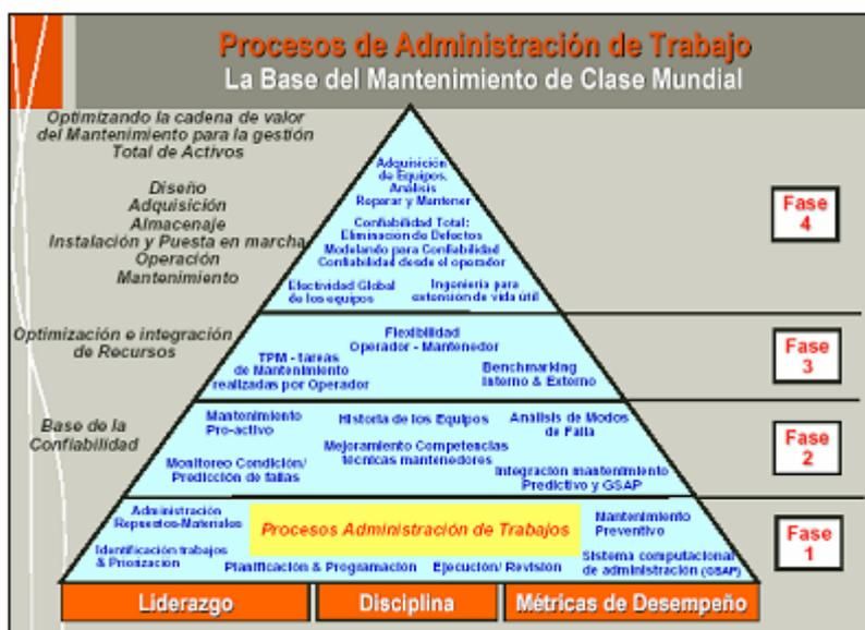
Figura 2.16: Bases del Mantenimiento de Clase Mundial
