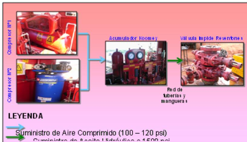
Figura 4.6: Flujograma del sistema neumático del taladro H-643
