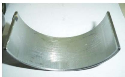
**Figura 4.54.** Cojinete de contacto deslizante utilizado en los ensayos de desgaste.
