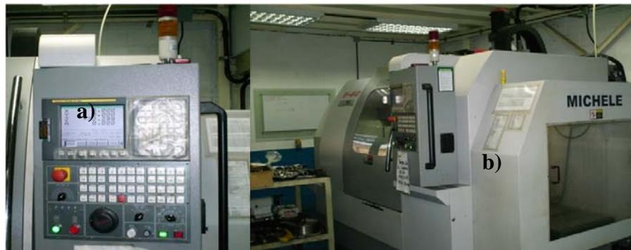
**Figura 3.6.** Centro de mecanizado asistido por computadora: a) Panel de control y b) Vista completa de la máquina herramienta.
