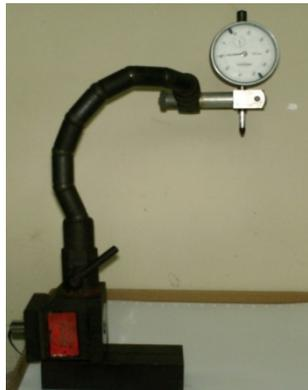
**Figura 3.8.** Reloj comparador, marca: Mitutoyo, apreciación: 0,001 mm, rango 0-10 mm.
