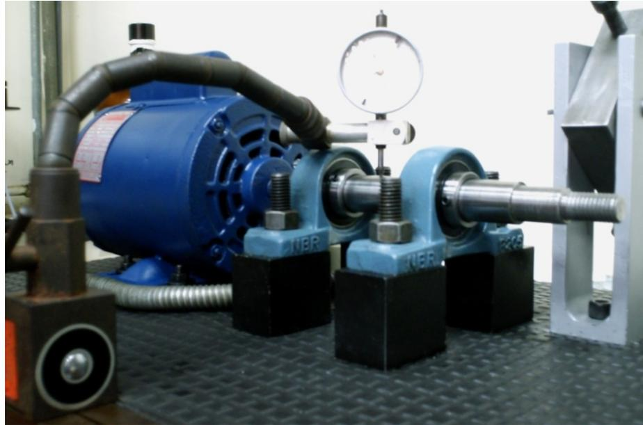
**Figura 4.51.** Instalación del reloj comparador en el equipo.
