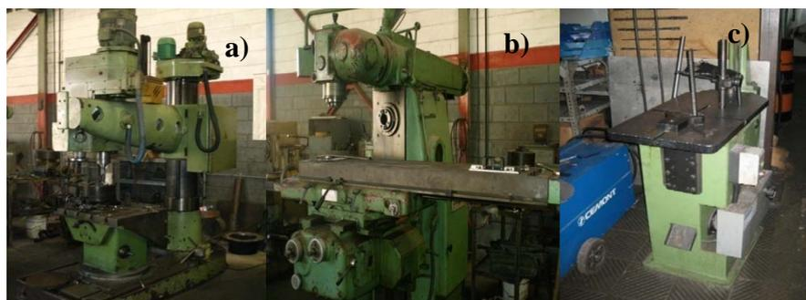
**Figura 3.7.** Máquinas herramientas semiautomáticas utilizadas: a) Taladro de banco, b) fresadora y c) brochadora.
