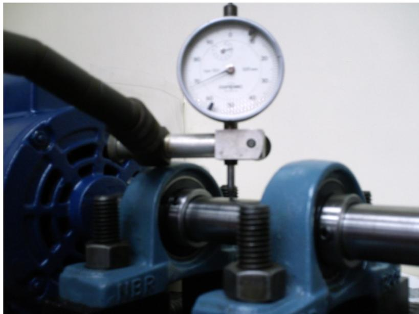
**Figura 4.52.** Instalación del reloj comparador en los diferentes puntos del eje de transmisión de potencia.
