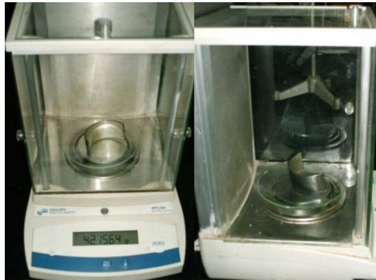
**Figura 4.55.** Balanza analítica utilizada para determinar el peso de los cojinetes de contacto deslizante.
