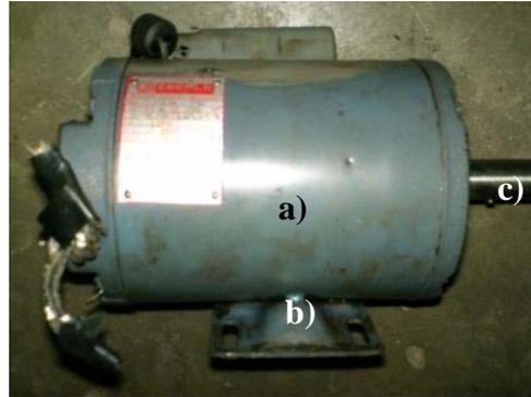
**Figura 4.1.** Motor eléctrico empleado en el equipo para el estudio del desgaste: a) Motor, b) Base de anclaje y c) Eje de salida
