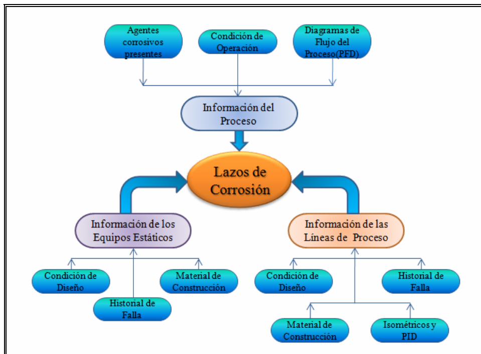
Figura 3.1. Esquema para la selección de lazos de corrosión
