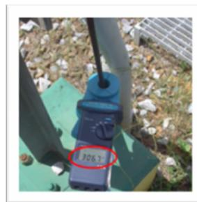
Pozo de prueba y medición de continuidad en conductor de conexión a tierra
