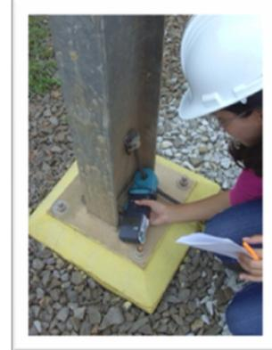
Mediciones de continuidad en los conductores de conexión a tierra.
