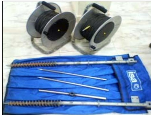
**Electrodos de hincamiento y cables del equipo.**
