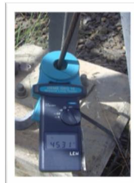
Pozo de prueba y medición de continuidad en conductor de conexión a tierra
