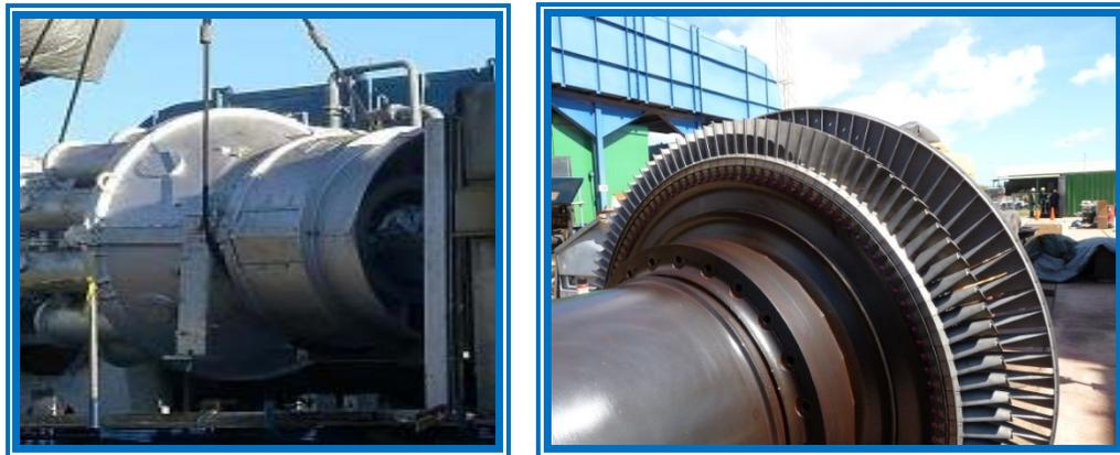
**Figura 4.7. Modelo de Turbina y rueda de turbina de las Unidades Turbogeneradoras FRAME [Propia]**
