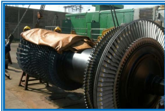
**Figura 4.6. Compresor de flujo Axial de las Unidades Turbogeneradoras [Propia]**
