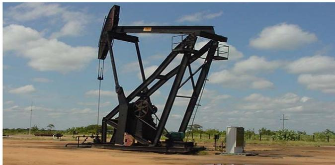
**Figura 2.28. Sistema de Levantamiento Artificial por Bombeo Mecánico.**
