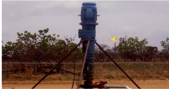
**Figura 2.29. Unidad de Levantamiento Artificial por Cavity Progressiva.**
