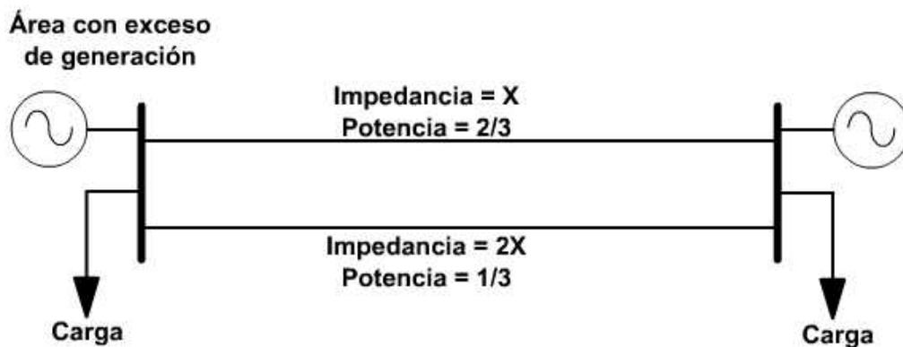
**Figura 4.1** Flujo de potencia en líneas paralelas [5]
