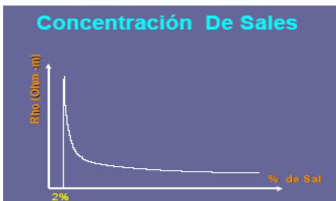
Figura 2.3 Variación de la resistividad del terreno en función del % de sal.
