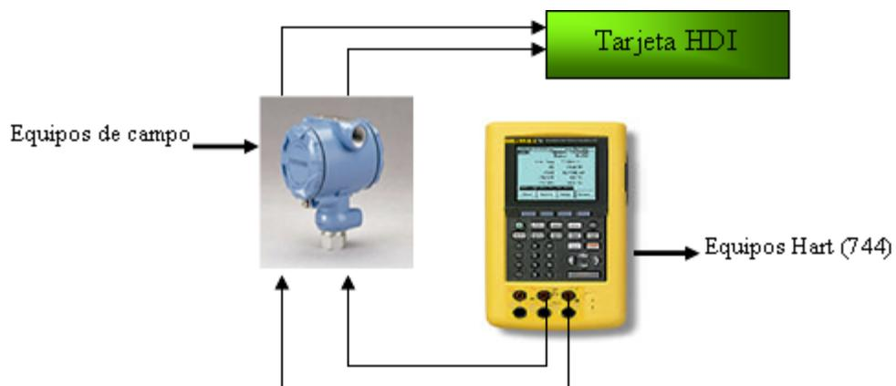
Figura 3.20. Conexión y configuración de los equipos de campo.
