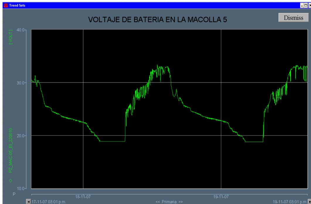
Figura 4.5 Tendencia del voltaje de baterías para el día 18/11/07
