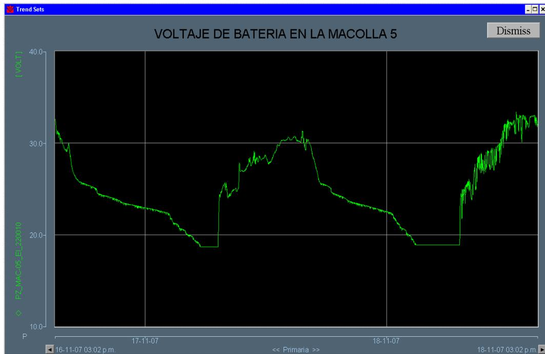
Figura 4.4 Tendencia del voltaje de baterías para el día 17/11/07
