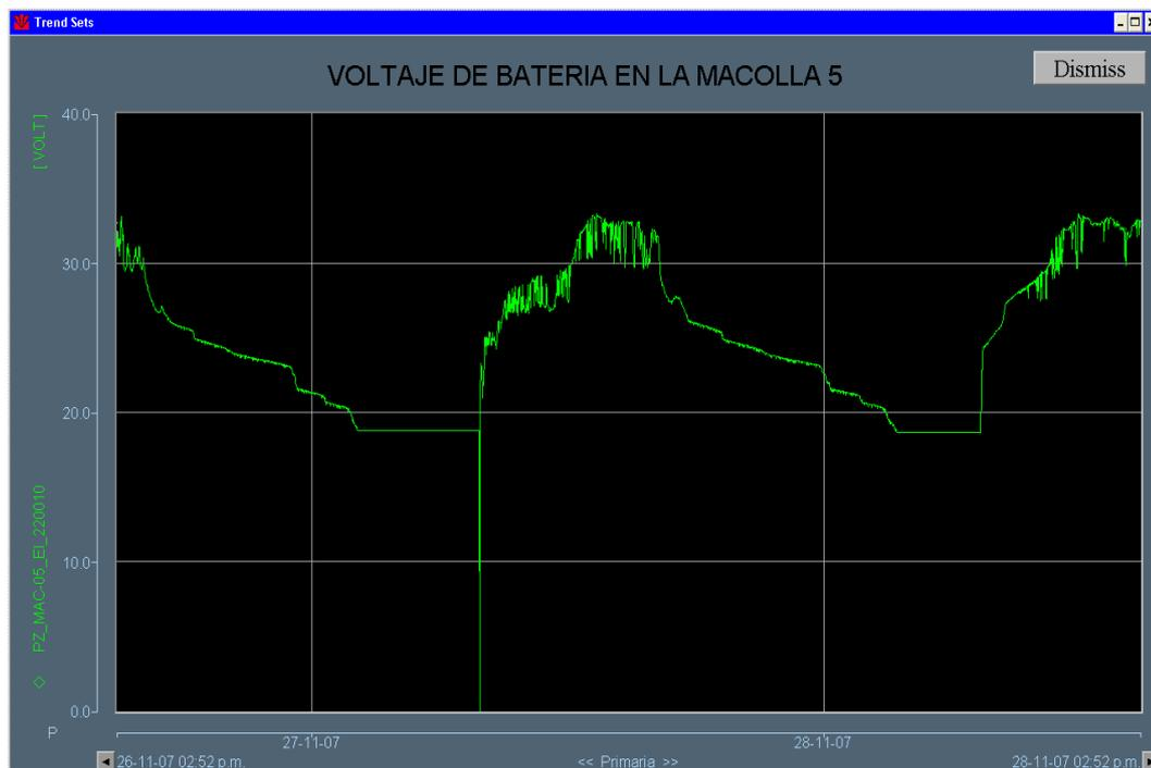
Figura 4.6 Tendencia del voltaje de baterías para el día 27/11/07
