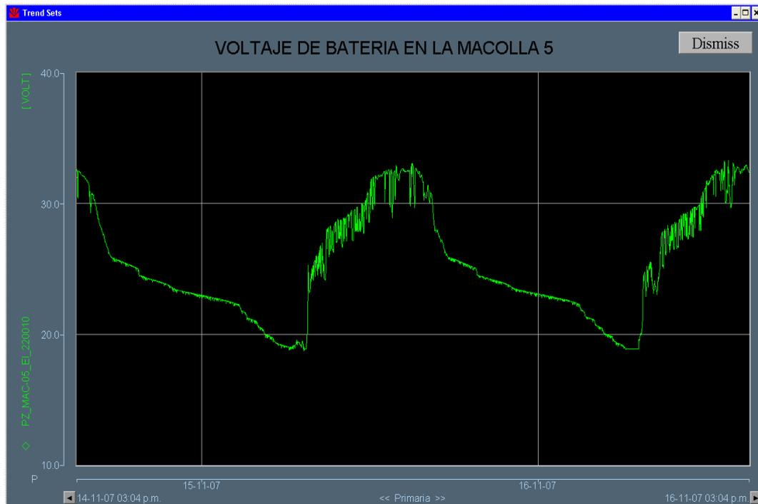
Figura 4.2 Tendencia del voltaje de baterías para el día 15/11/07
