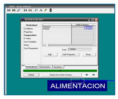
Figura 3.6 Ingreso de la composición de la corriente de alimentación
