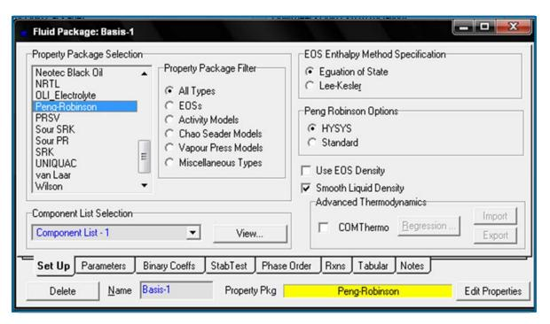
Figura 3.3 Selección del paquete termodinámico
