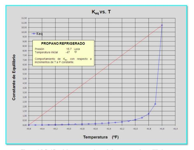
Figura 4.5 Gráfica del comportamiento de la constante de equilibrio termodinámico con respecto a la temperatura
