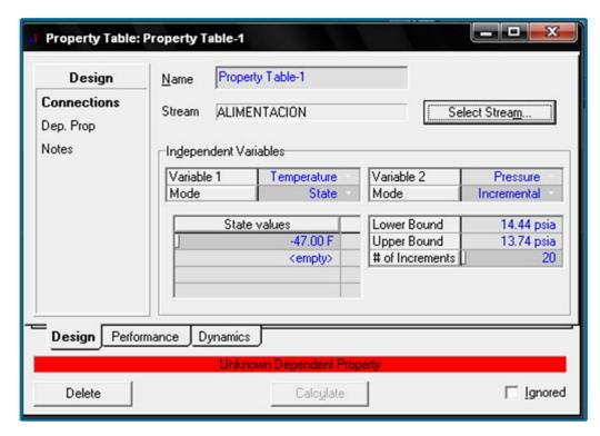
Figura 3.11 Selección del rango de la variable a calcular
