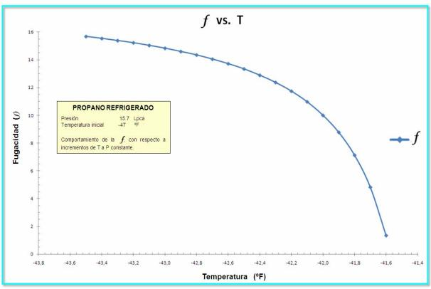
Figura 4.7 Gráfica del Comportamiento de la fugacidad con respecto a la temperatura
