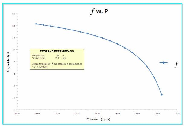
Figura 4.4 Gráfica del comportamiento de la fugacidad con respecto a la presión
