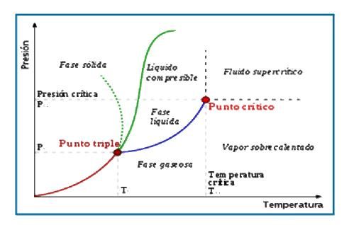
Figura 2.7 Diagrama de fases general (P vs. T), para compuestos puros
