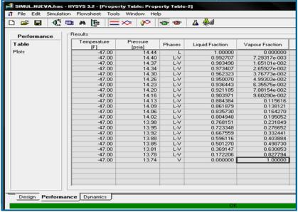
Figura 3.12 Fracciones de vapor y liquido obtenidos al variar la presión manteniendo la temperatura constante
