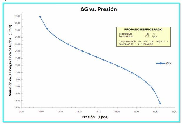
Figura 4.3 Gráfica del comportamiento de la energía libre de Gibbs con respecto a la presión
