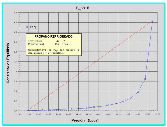
Figura 4.2 Gráfica del comportamiento de la constante de equilibrio termodinámico con respecto a la presión
