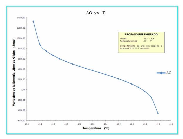
Figura 4.6 Gráfica del comportamiento de la energía libre de Gibbs con respecto a la temperatura
