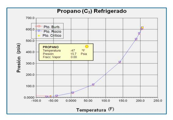
Figura 2.9 Diagrama de fases (P vs. T), para propano refrigerado
