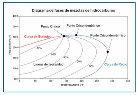
Figura 2.8 Diagrama de fases general (P vs. T), para sistemas multicomponentes (mezclas)
