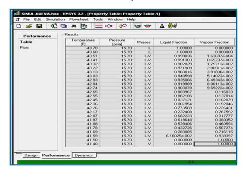
Figura 3.13 Fracciones de vapor y liquido obtenidos al variar la presión manteniendo la presión constante
