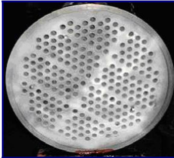
Figura 2.9 Cabezal de Tubos de un Intercambiador de Tubo y Coraza. <sup>[9]</sup>
