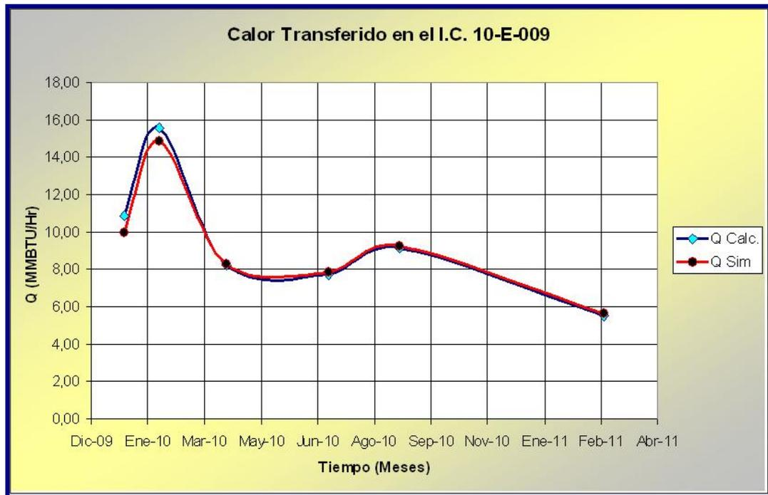
Figura 4.20 Resultados del Calor Transferido obtenidos a través del simulador PRO II y de los cálculos para el Intercambiador 10-E-009.
