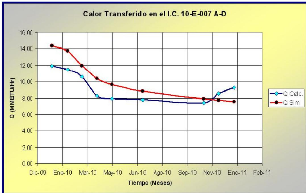
Figura 4.14 Resultados del Calor Transferido obtenidos a través del simulador PRO II y de los cálculos para los Intercambiadores 10-E-007 A-D.
