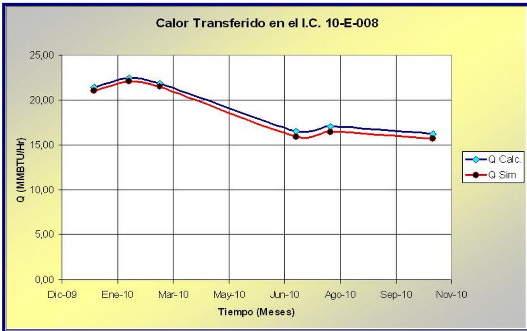
Figura 4.17 Resultados del Calor Transferido obtenidos a través del simulador PRO II y de los cálculos para el Intercambiador 10-E-008.
