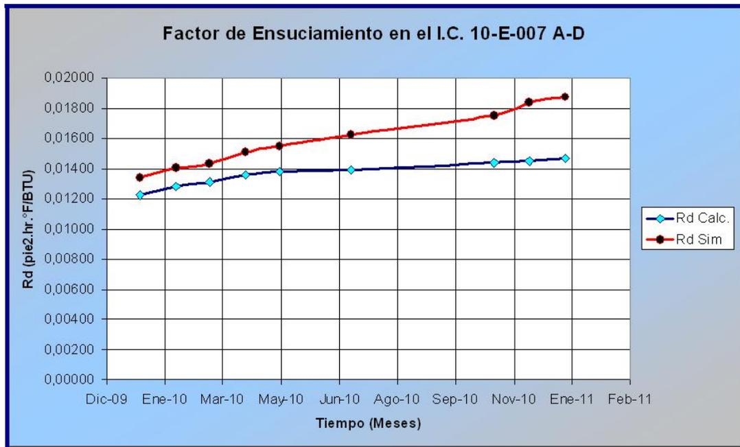
**Figura 4.16** Resultados del Factor de Ensuciamiento obtenidos a través del simulador PRO II y de los cálculos para los Intercambiadores 10-E-007 A-D.
