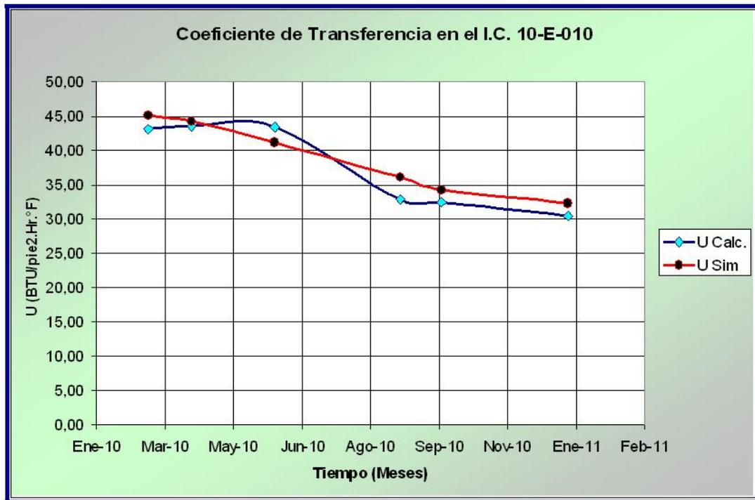
Figura 4.24 Resultados del Coeficiente Total obtenidos a través del simulador PRO II y de los cálculos para el Intercambiador 10-E-010.
