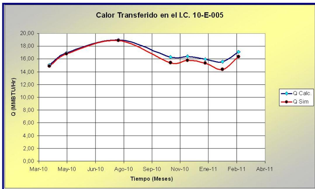
**Figura 4.8 Resultados del Calor Transferido obtenidos a través del simulador PRO II y de los cálculos para el Intercambiador 10-E-005.**
