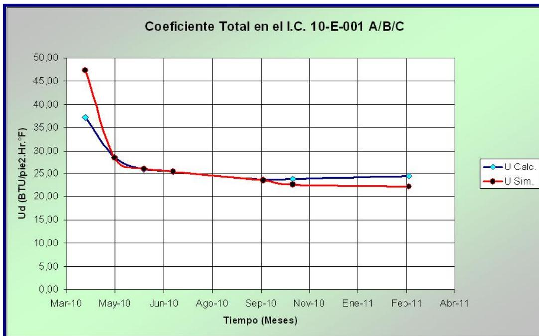
Figura 4.3 Resultados del Coeficiente Total obtenidos a través del simulador PRO II y de los cálculos para los Intercambiadores 10-E-001 A/B/C.
