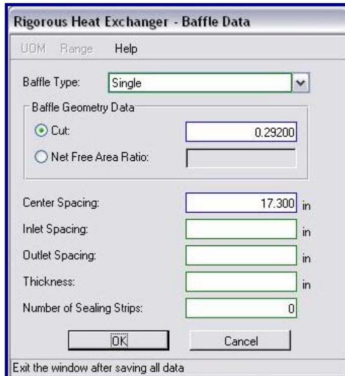
Figura 2.22 Ventana Datos de los Deflectores del Intercambiador de Calor Riguroso. [Propia]
