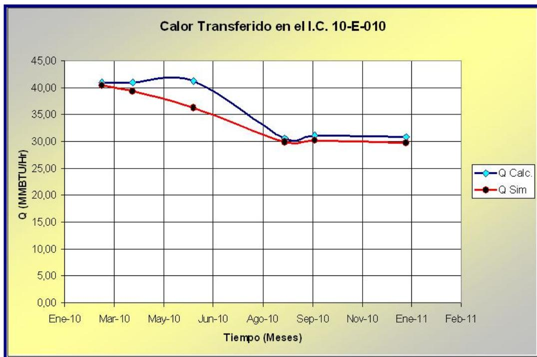
**Figura 4.23** Resultados del Calor Transferido obtenidos a través del simulador PRO II y de los cálculos para el Intercambiador 10-E-010.
