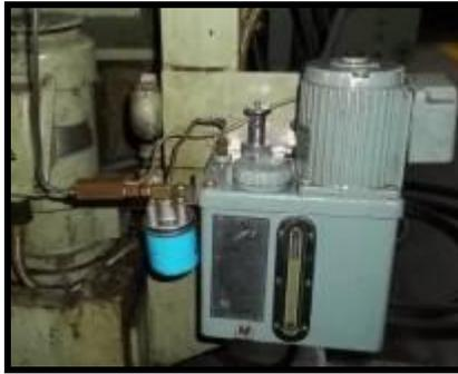
**Figura 4.14**Bomba de lubricación de guías
