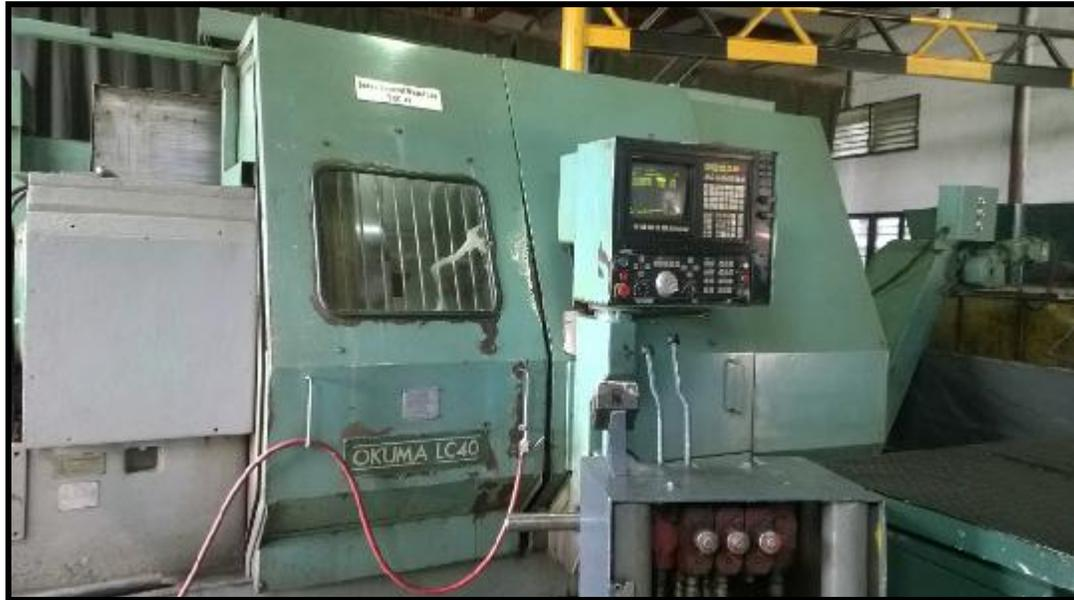
**Figura 4.7 Torno de control numérico OKUMA**
