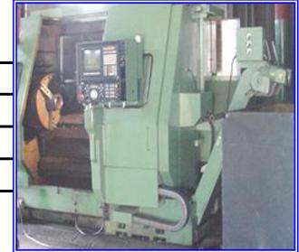
**Funcionamiento y Manejo:** Es utilizado con el objeto de dirigir seis movimientos lineales independientes, obteniendo incluso perfiles de piezas complicadas, torneado de elementos de gran tamaño como rodetes de turbinas grandes, volantes y poleas, ruedas dentadas etc, que debido a su gran peso debe montarse sobre una plataforma horizontal.
