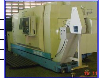
**Funcionamiento y Manejo:** Es utilizado con el objeto de dirigir seis movimientos lineales independientes, obteniendo incluso perfiles de piezas complicadas torneado de elementos de gran tamaño como rodetes de turbinas grandes, volantes y poleas, ruedas dentadas etc, que debido a su gran peso debe montarse sobre una plataforma horizontal.
