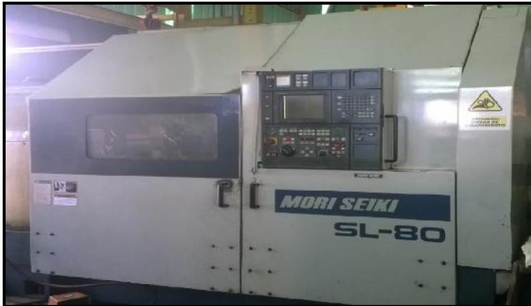
**Figura 4.6**Torno de control numérico MORI-SEIKI
