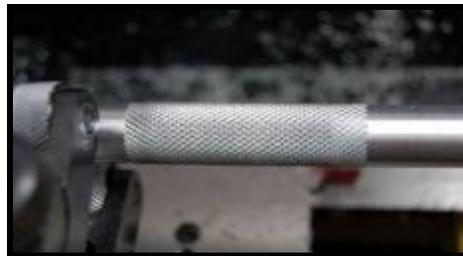
**Figura 2.9**Esquema funcional de moleteado.
