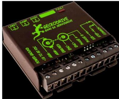
**Figura 4.19. Tarjeta de control motor portaherramientas**
