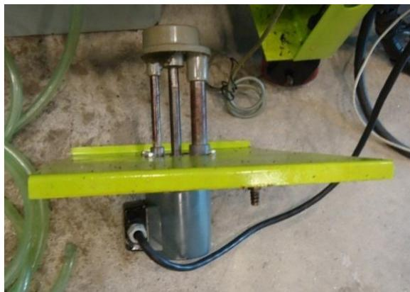
**Fig. 4.13. Motobomba del sistema de refrigeración**
