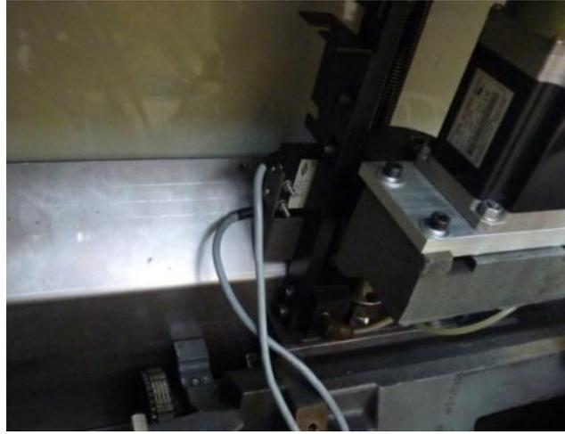
**Figura 4.15. Ubicación de sensores inductivos eje X**
