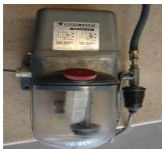
**Figura 4.11. Bomba de lubricación centralizada**
