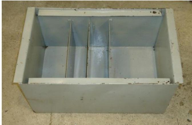
**Figura 4.14. Recipiente de almacenamiento fluido refrigeración**
