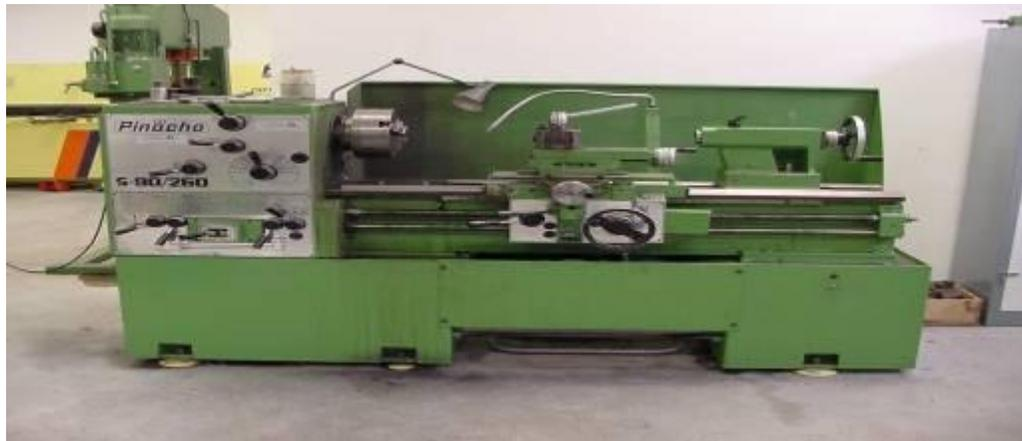
**Figura 2.3. Vista lateral del torno paralelo**
