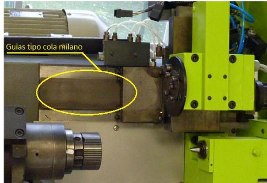
**Figura. 4.5. Guías lineales de desplazamiento**
