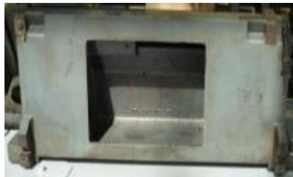
**Figura 4.4. Bancada revestida en fundición gris**
