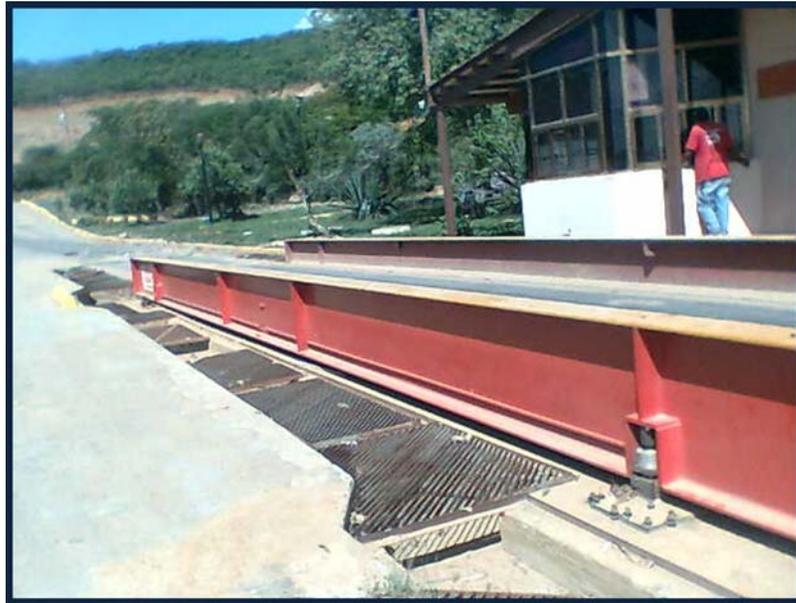
**Figura 3.14 Balanza (romana) utilizada para pesar los camiones y compactadores en el relleno sanitario.**
