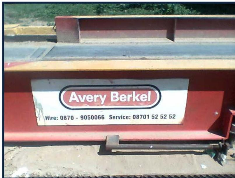
**Figura 3.15 Balanza (romana) utilizada para pesar los camiones.**
