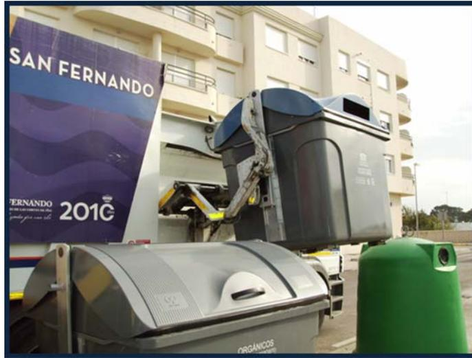
**Figura 2.9:** Vehículo compactador de carga lateral<sup>14</sup>
