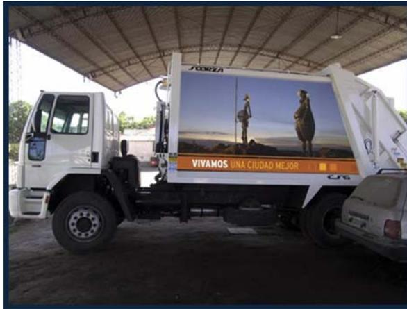
**Figura 2.10:** Vehículo compactador de carga trasera<sup>14</sup>
