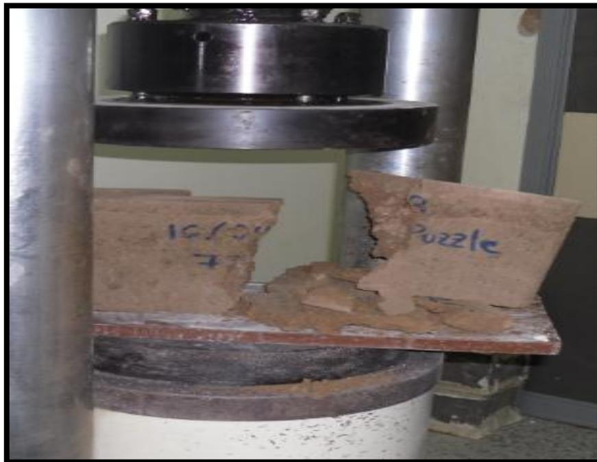
Figura 4.36 Ruptura del Bloque
