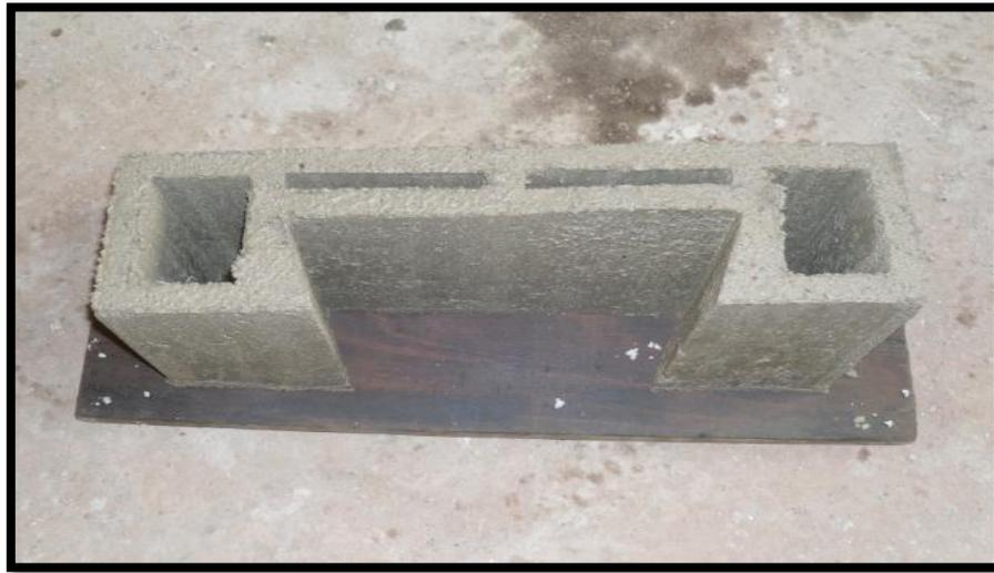
Figura 4.28 Bloque desmoldado
