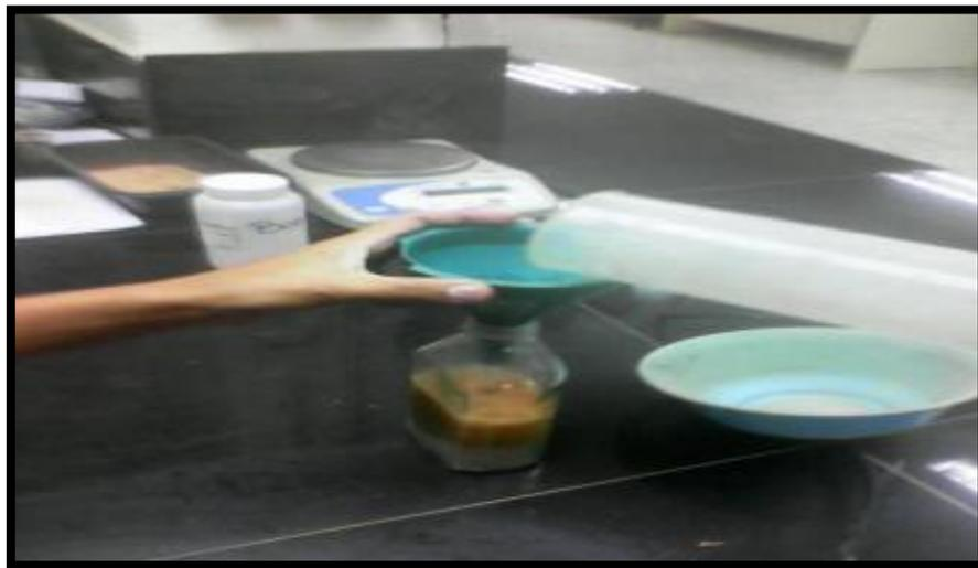
Figura 4.17 Inmersión de la muestra en el sodio de hidróxido
