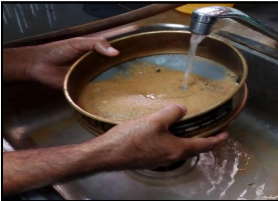
Figura 4.8 Lavado de una de las muestras de arena
