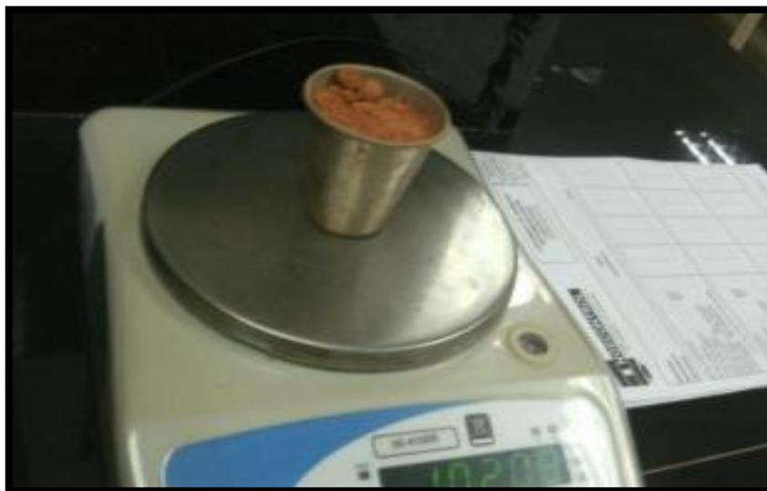
Figura 4.16 Ensayo de humedad de la arena
