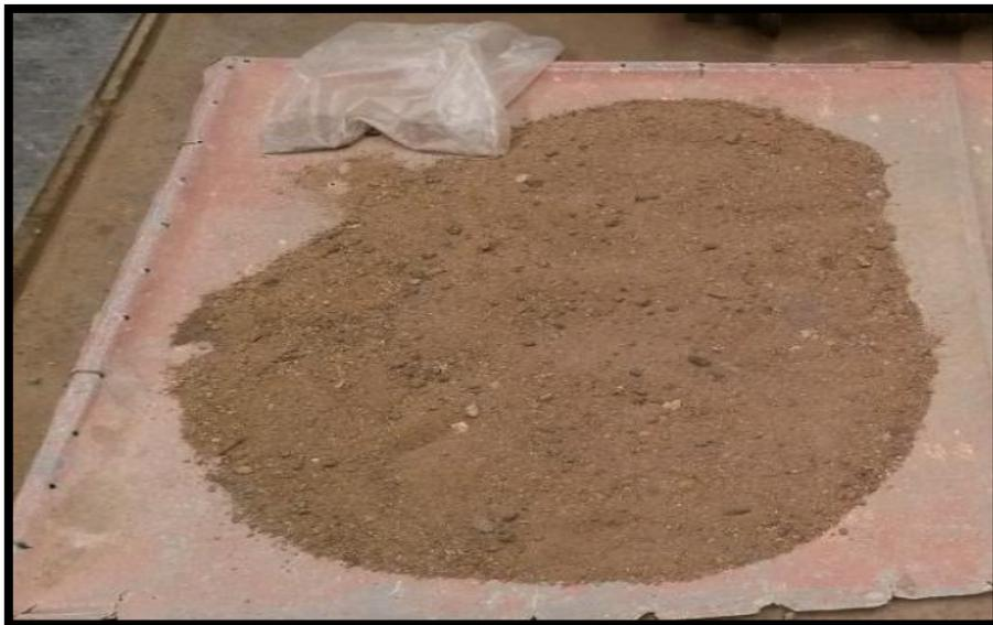
Figura 4.20 Tipo de arena usada en la elaboración del bloque
