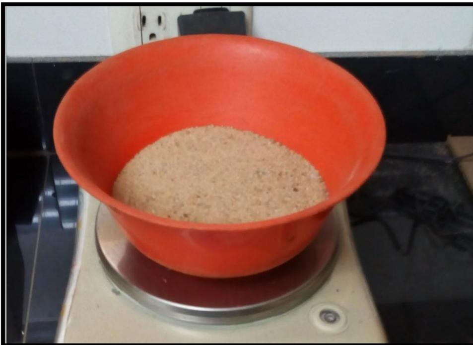
Figura 4.12 Muestra de la arena luego del ensayo granulométrico
