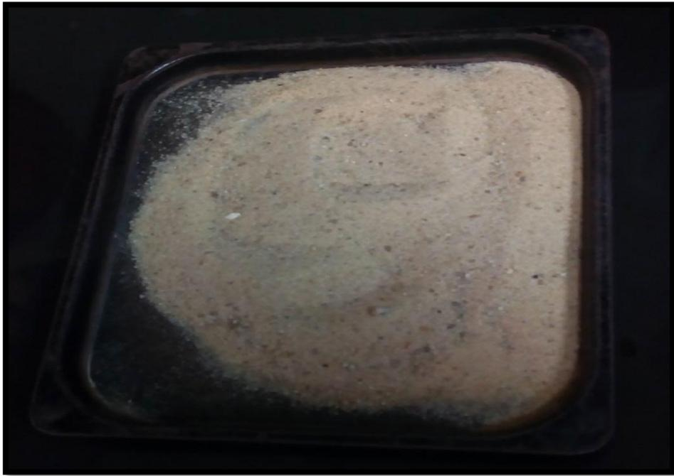
Figura 4.11 Muestra de la arena seca después de retirada del horno
