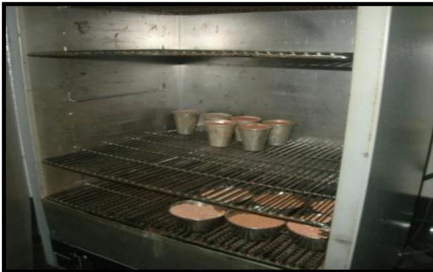
Figura 4.15 Arenas colocadas en el horno para ensayo de humedad
