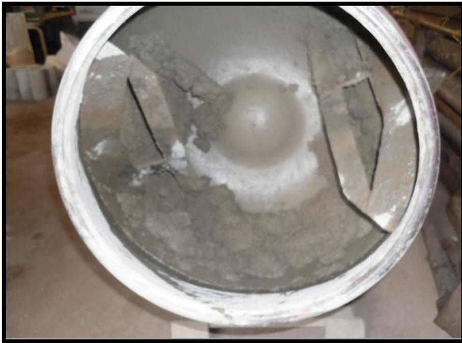
Figura 4.25 Mezcla homogénea de consistencia deseada
