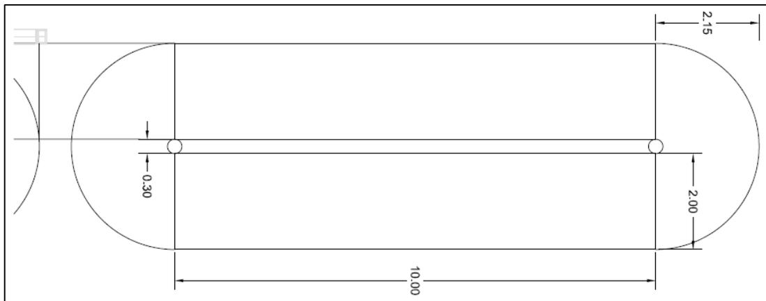
Figura 5.32 Detalle rampa(planta).
