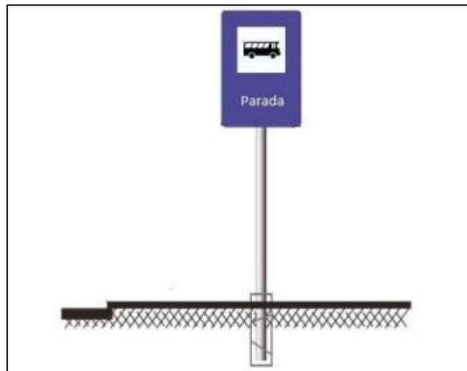
Figura 3.4 Señal vertical de parada (vista frontal).
