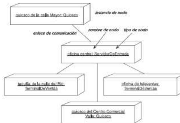
**Figura 20. Ejemplo de diagrama de despliegue (nivel de instancia).**
