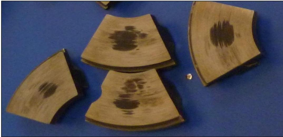
Figura 5.4 Cara de los cojinetes contaminados con petróleo ( Taller de Mantenimiento,2017)
