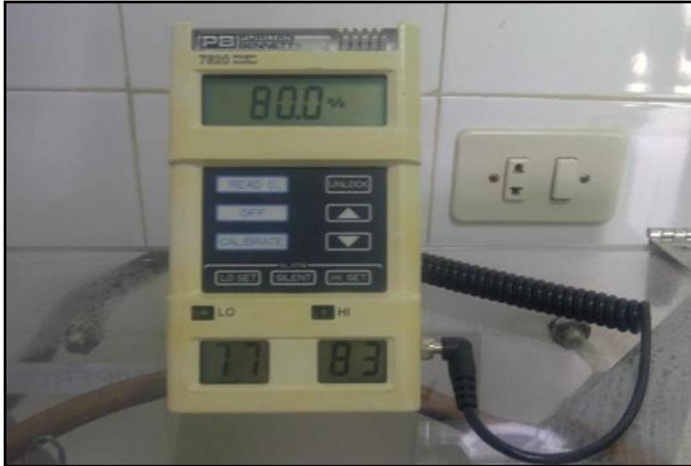
**Anexo 5.** Oxímetro utilizado en el diseño experimental.
