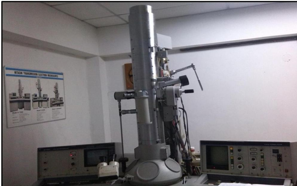
**Anexo 6.** Microscopio Electrónico de Transmisión marca Hitachi H-600, utilizado para observar cotes finos del tejido del hígado.
