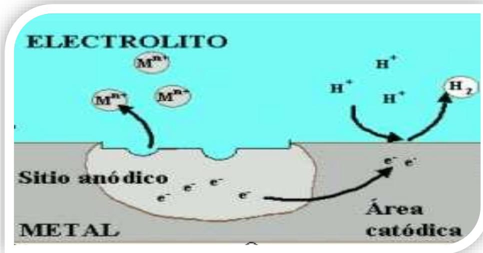
**Figura 2.-**Modelo simplificado de corrosión húmeda de un metal.
