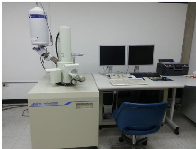
**Figura 17.-**Microscopio electrónico de barrido marca Jeol modelo JSM-6390 equipado con sonda Oxford Instruments INCA X-sight LN2 EDS modelo 7582.
