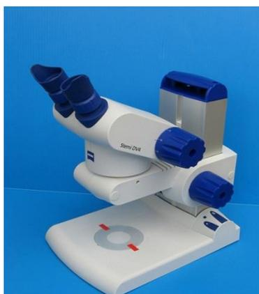
**Figura 16.-**Microscopio Zeiss Stemi DV4 utilizado para verificar la superficie de las muestras antes de evaluarlas electroquímicamente.
