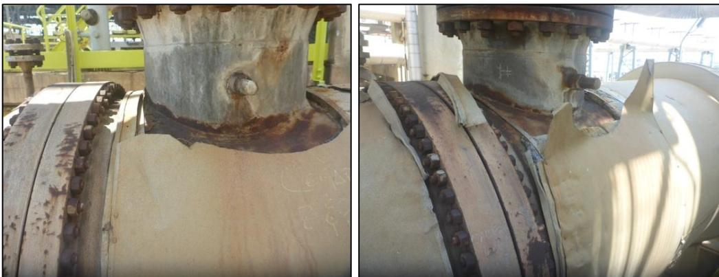
**Figura 4.26. Abolladuras y desprendimiento de la chaqueta metalica del intercambiador E-4103. Fuente: Supermetanol, C.A**
