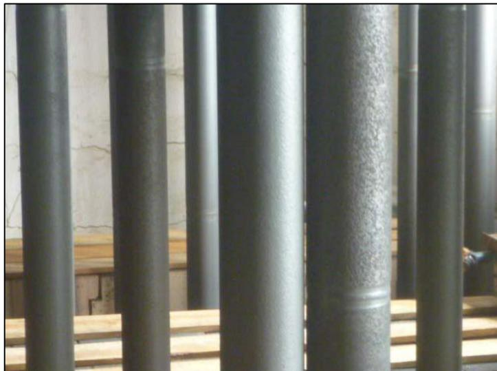
**Figura 4.10. Deformación del tubo catalítico número 64. Fuente:
