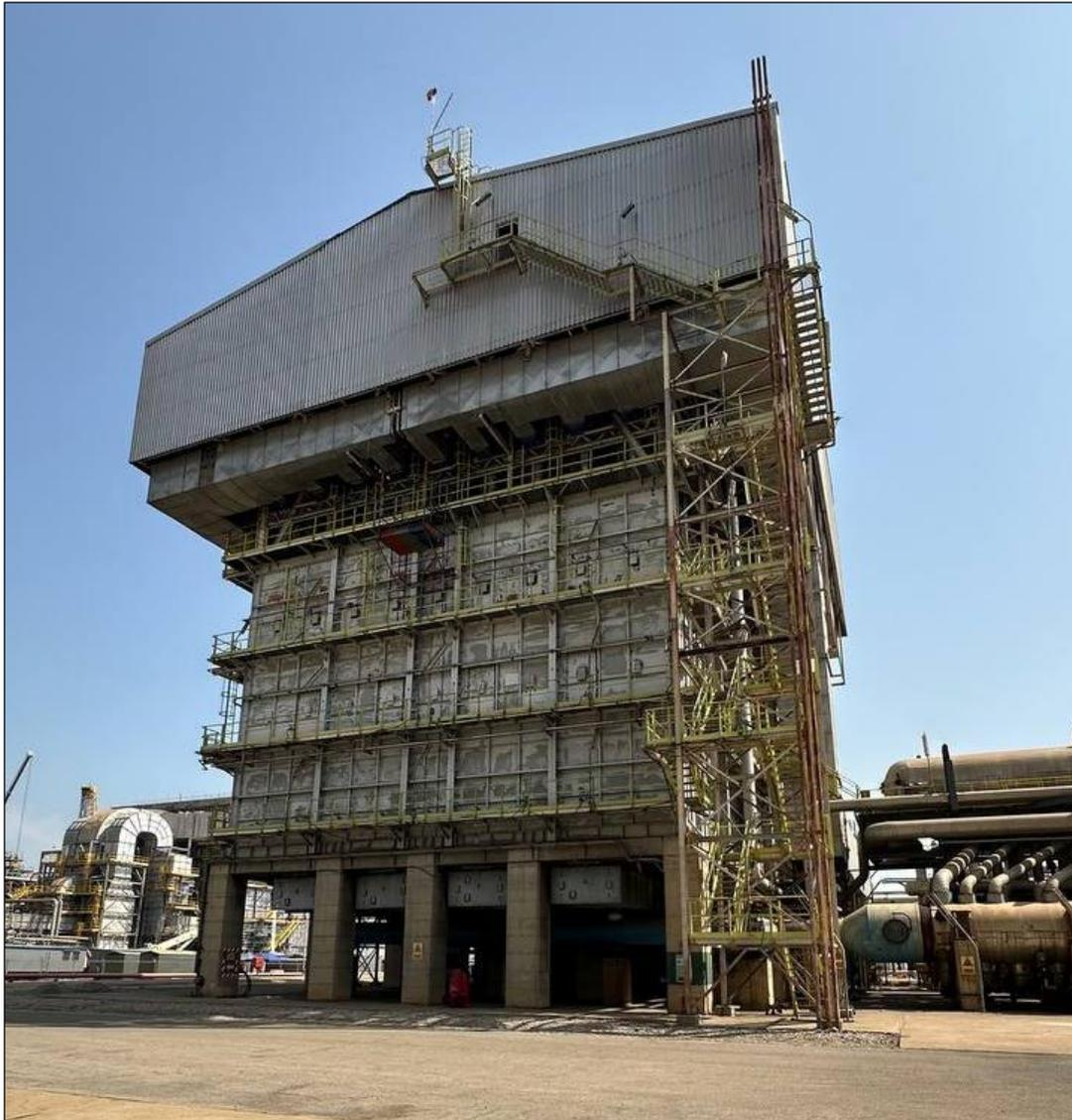
**Figura 4.2. Horno Reformador. Fuente: Supermetanol, C.A**
