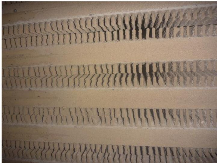
**Figura 4.20. Sedimentos presentes en placas del intercambiador E-4114.**
