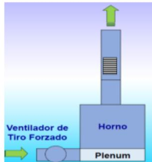
Figura 2.8. Esquema de horno tiro forzado. Fuente: ESENERM (2014)
