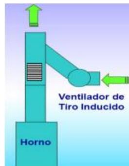
Figura 2.7. Esquema de horno tiro inducido. Fuente: ESENTERM (2014)
