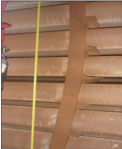
**Figura 4.17. Deformación plástica de placa tubular intermedia del E-4112A. Fuente: Supermetanol, C.A**
