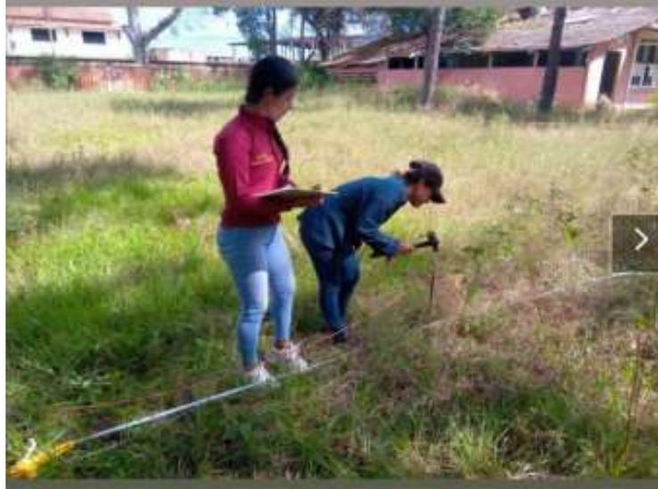
Figura 5.14 Proceso de hincado de electrodos.
