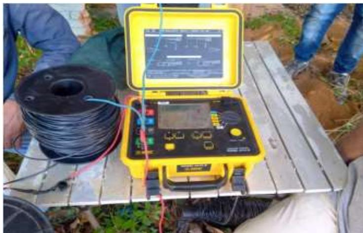
Figura 5.13 Equipo para realizar el Sondeo Eléctrico Vertical
