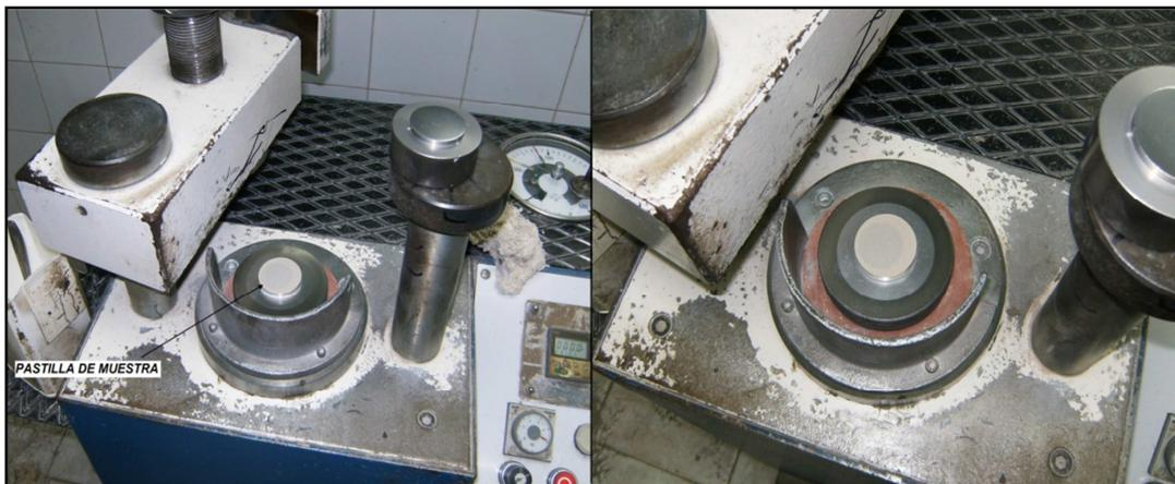
Figura 4.7 Creación de la pastilla usada para el análisis de Rx.
