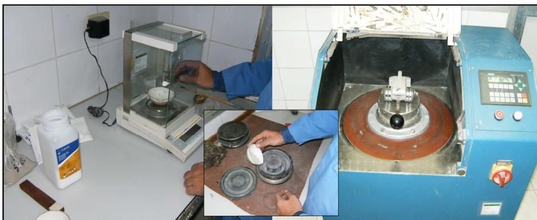
Figura 4.6 Preparación de la muestra para la pastilla.
