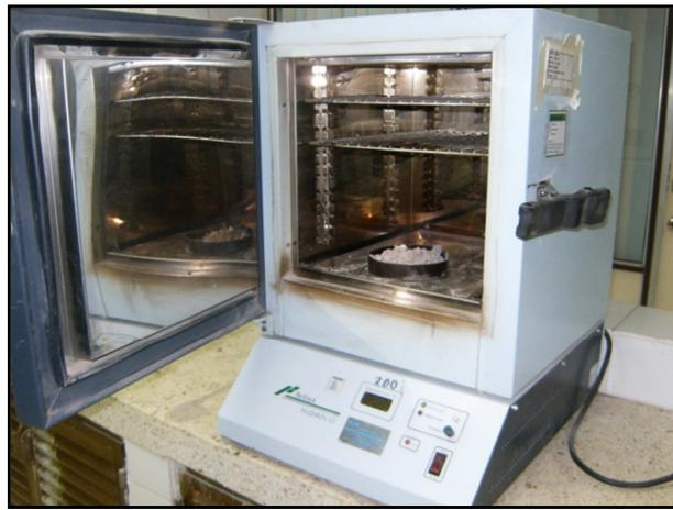
Figura 4.4 Secado al horno de la muestra.
