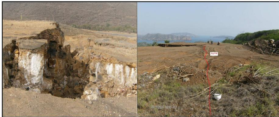
Figura 5.11 Corona del deslizamiento y grietas secundarias de la corona.
