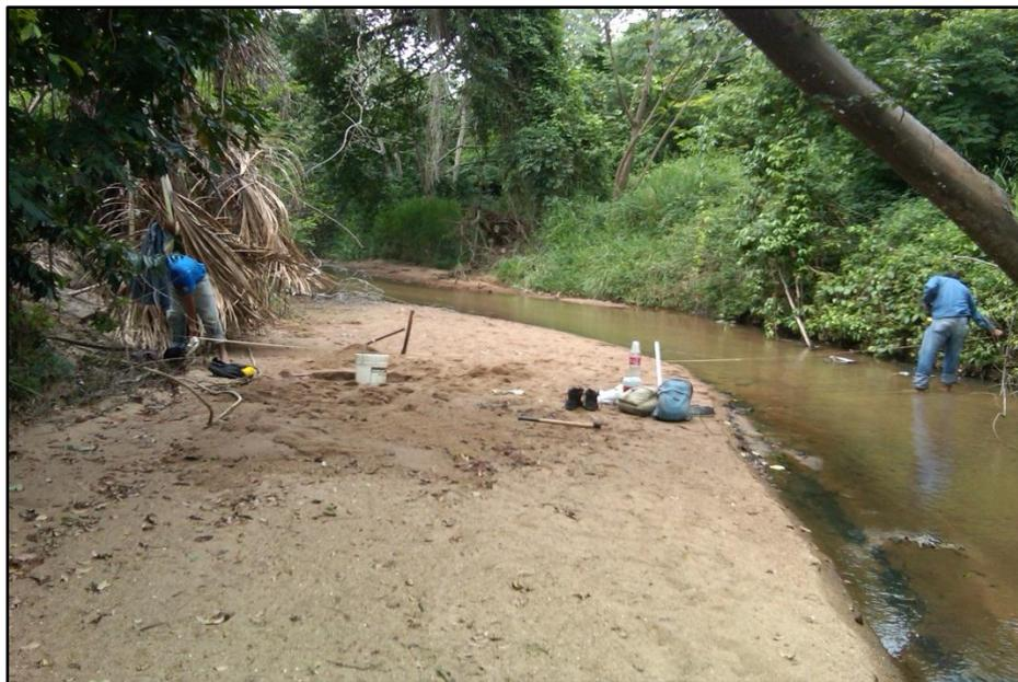
Figura 4.4 Medición del Cauce del río con cinta métrica.
