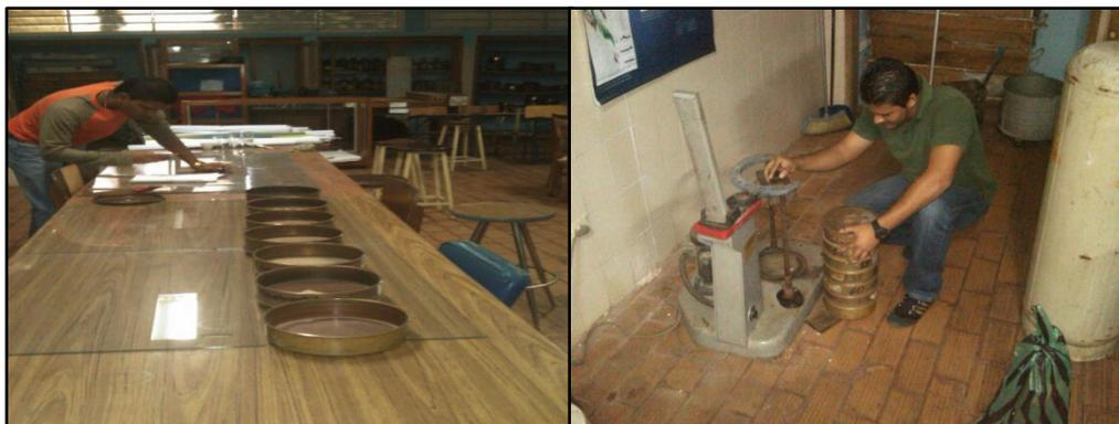
Figura 4.5 Análisis Granulométrico por Tamizado.
