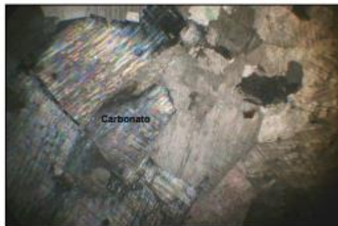
Muestra RS-2 NX (10X/4X): Se observa carbonato anhedral a subhedral, de tamaño grueso a medio con maclas polisintéticas.
