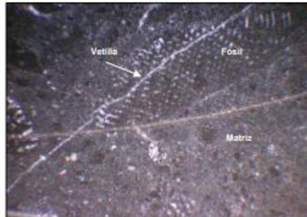
Muestra E6-AF6-M1 NX (10X/4X): Se observa textura biomicrítica, en una matriz de lodo calcáreo (micrítico), restos fósiles atravesado por vetillas carbonáticas.
