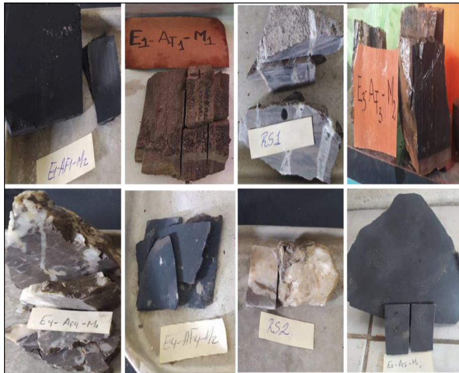
Figura 4.9 Muestras de rocas carbonáticas cortadas y en lajas
