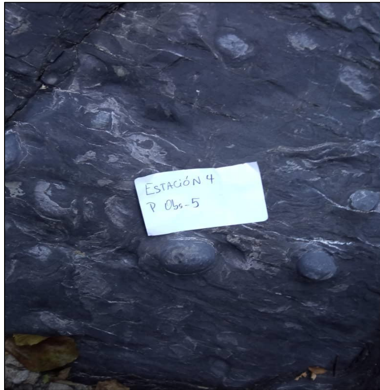
Figura 5.25 Concreciones de caliza biomicrítica con ooides, en matriz de roca caliza biomicrítica de grano muy fino color grisácea
