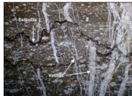
Muestra RS-1 (N//) 10X/2X: Se observa las estructuras presentes, vetillas paralelas rellenas de carbonato y estilolitas perpendicular a las vetillas.
