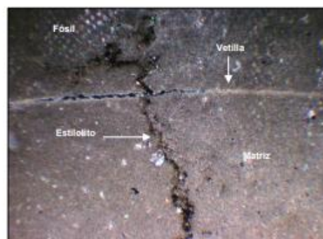
Muestra E6-AF6-M1 NX (10X/4X): Se observa una matriz de lodo calcáreo (micrítico), restos fósiles, estilolitas y vetillas carbonáticas.
