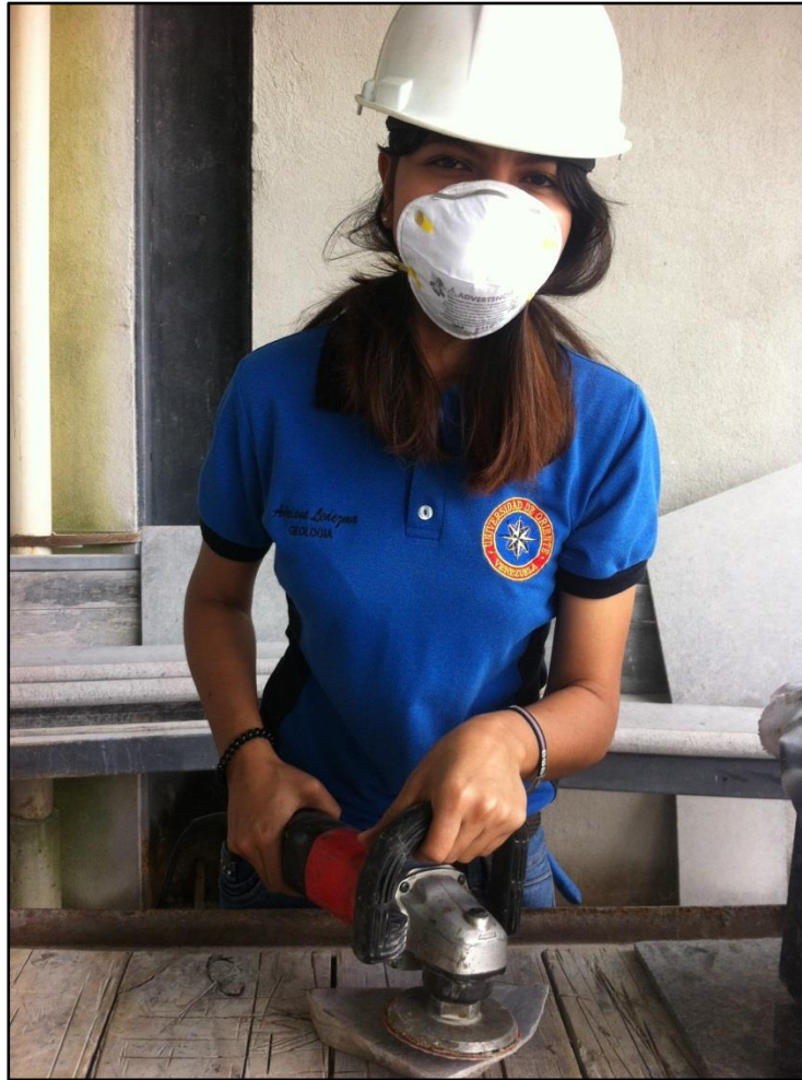
Figura 4.7 Pulido de la muestra de gneis rosado, usando herramientas manuales.
