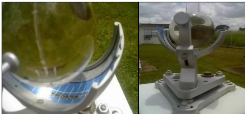
Figura 2.6 Actinógrafo, Instrumento usado para medir la radiación solar.
