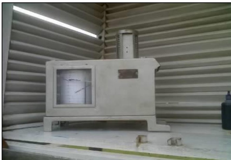
Figura 2.7 Hidrógrafo, instrumento usado para medir la Humedad relativa.
