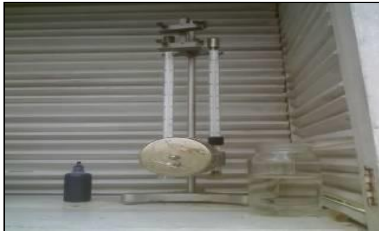
Figura 2.5 Psicrómetro, instrumento usado para medir la temperatura del aire.
