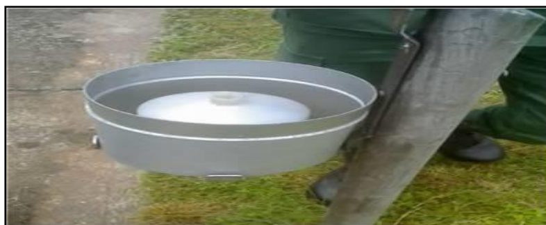
Figura 2.3 Pluviómetro usado para medir la precipitación.
