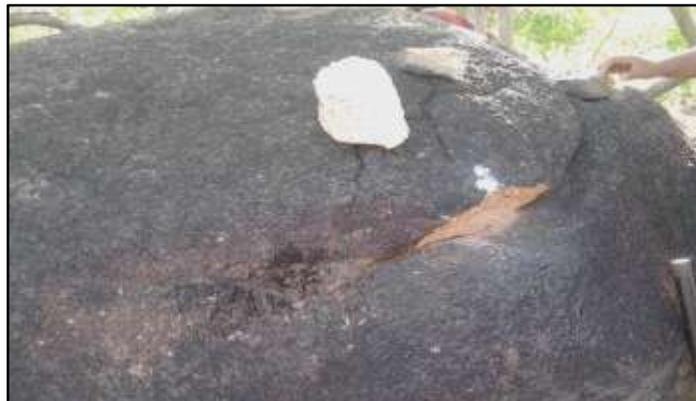
Figura 4.5 Muestreo de rocas mediante el método de percusión.
