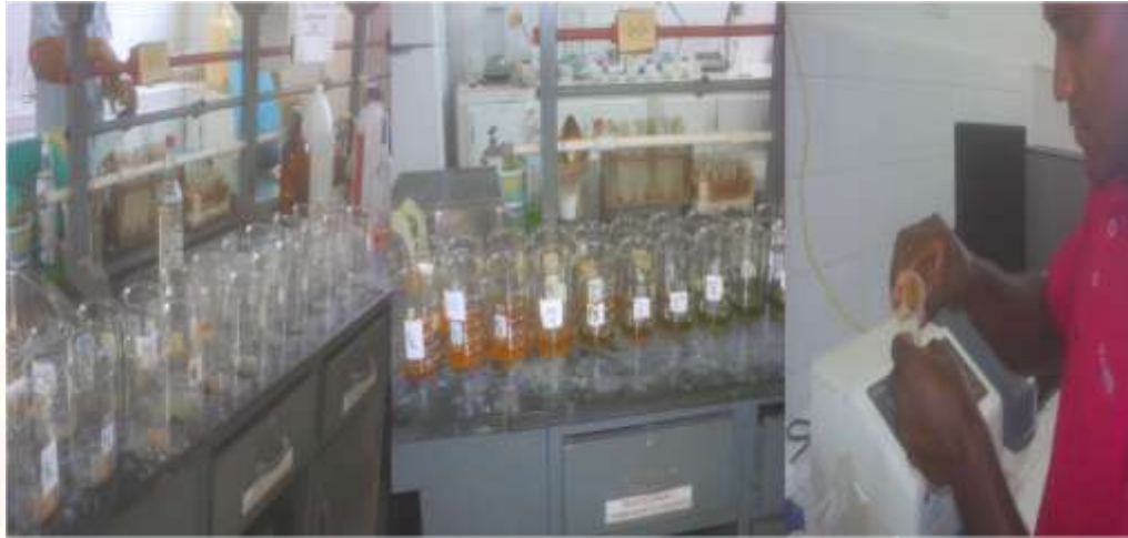
Figura 13. Determinación de materia orgánica a las diferentes combinaciones de arena de río y tierra negra para determinar así el porcentaje de nitrógeno total y asimilable a los diferentes tratamientos.
