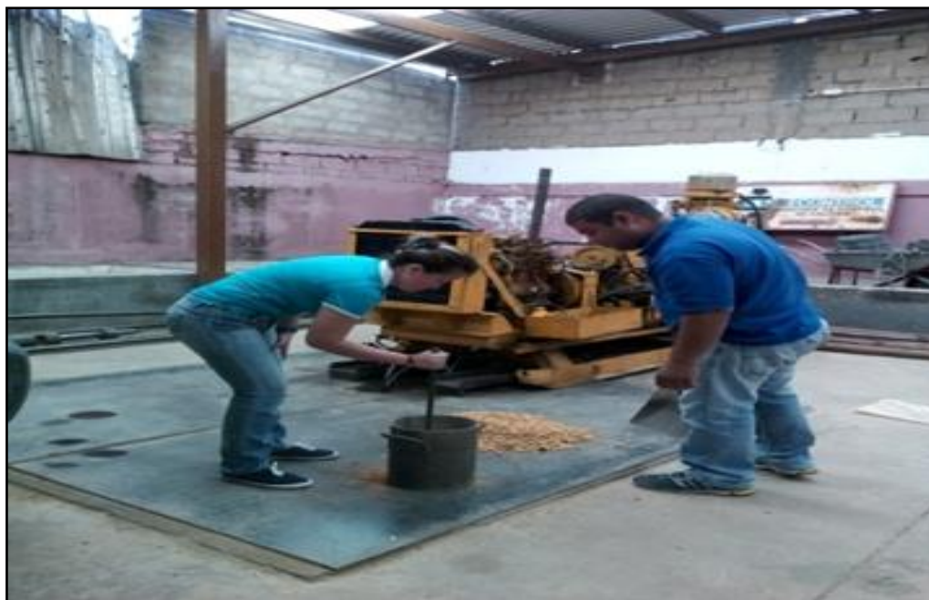
Figura 4.10 Compactación de la muestra de grava, para el ensayo de peso unitario.
