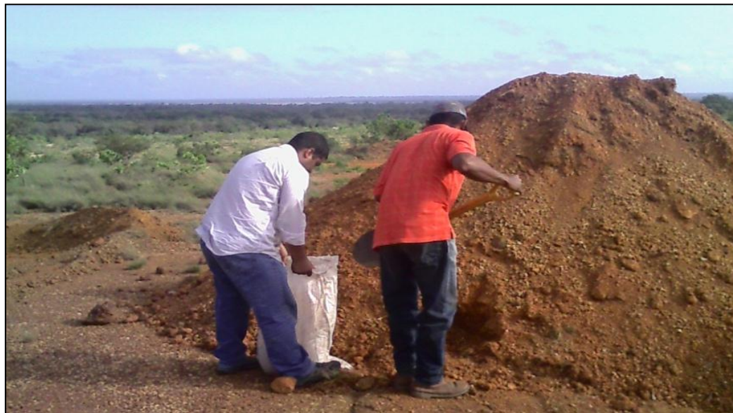
Figura 4.4 Muestreo manual del material gravoso apilado en el Fundo San Antonio.
