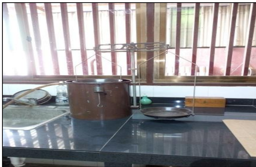
Figura 4.9 Cesta sumergida con muestra, para el examen de absorción.
