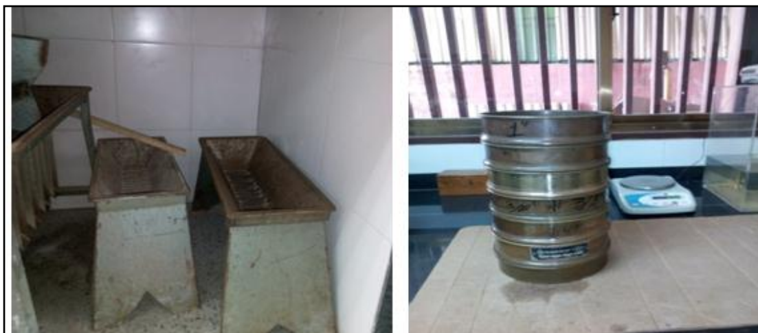
Figura 4.6 Cuarteador y batería de tamices, alineados en orden decreciente, según la malla.
