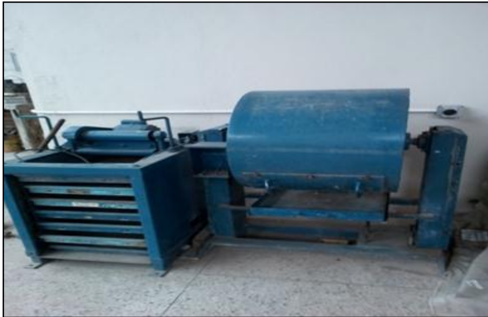
Figura 4.7 Máquina para determinar el desgaste de las muestras por abrasión.
