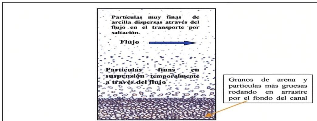
Figura 3.5 Flujo de corriente a través de la capa de arena, limo y arcilla mostrando su medio de transporte (Modificado de Hjulstrum, F., 1935).
