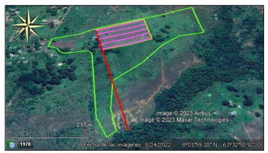
Figura 5.4 Trazado en planta de los canales secundarios o laterales (líneas lila) y el colector principal (línea roja).
