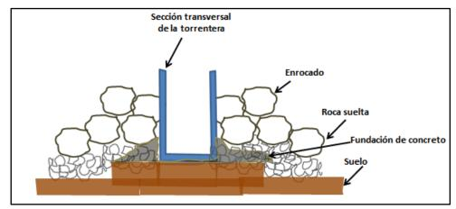
Figura 6.3 Sección transversal de una torrentera con protección de enrocado
