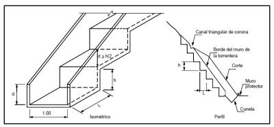
Figura 3.2 Torrentera en gradería (Aristizabal et al,2013).
