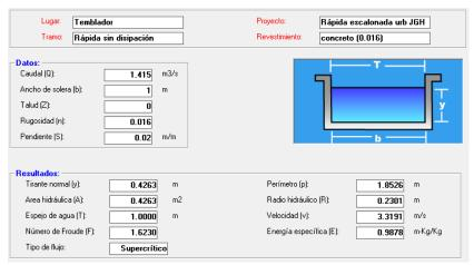
Figura 5.13 Cálculo de los parámetros hidráulicos y geométricos de la rápida (sin disipación de energía).
