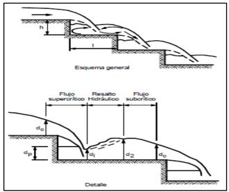
Figura 3.4 Régimen de flujo saltante sobre un canal en gradería (Mejía, 1999).
