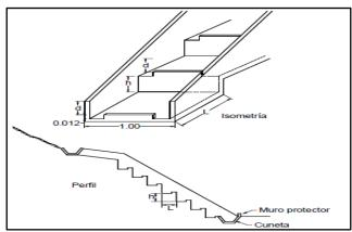
Figura 3.3 Torrentera en gradería con bloques en el fondo (Aristizábal et al, 2013).
