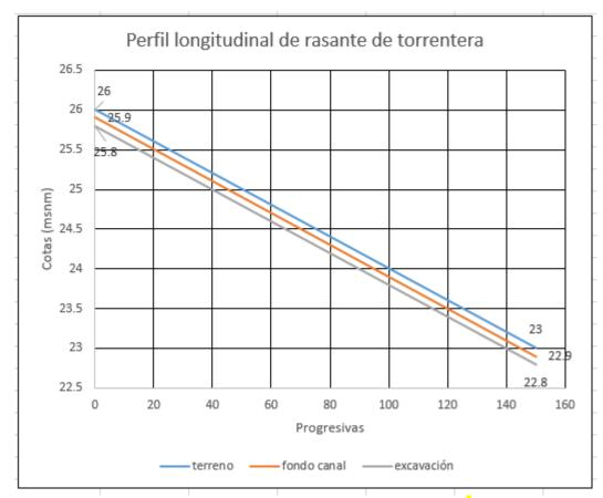
Figura 5.12 Perfil longitudinal de la torrentera.
