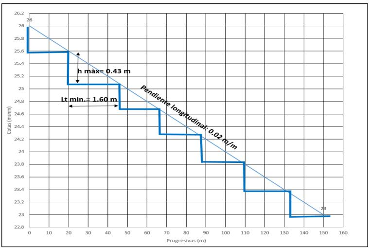
Figura 6.2 Perfil longitudinal de la torrentera
