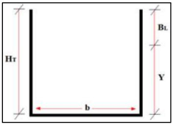
Figura 6.1 Esquema de la sección transversal de la torrentera o rápida escalonada.
