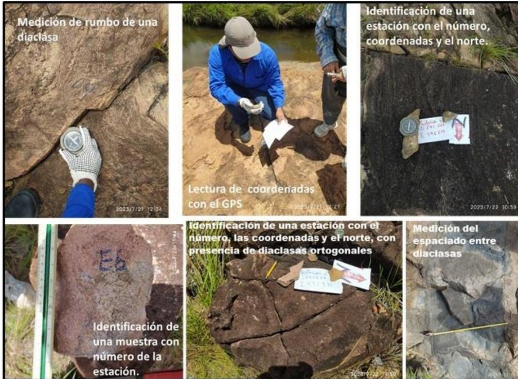
Figura 4.2 Medición de rumbos de las estructuras, identificación de las estaciones y las muestras.
