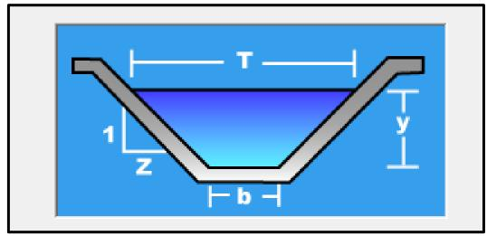
B.2 sección transversal de los canales transversales de la av. Paseo Orinoco
