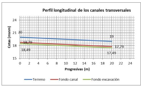
A.3 perfil longitudinal de los canales transversales av. Paseo Orinoco.
