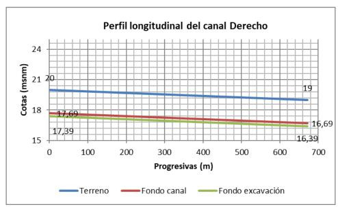
A.1 perfil longitudinal del canal derecho tramo av. paseo Orinoco
