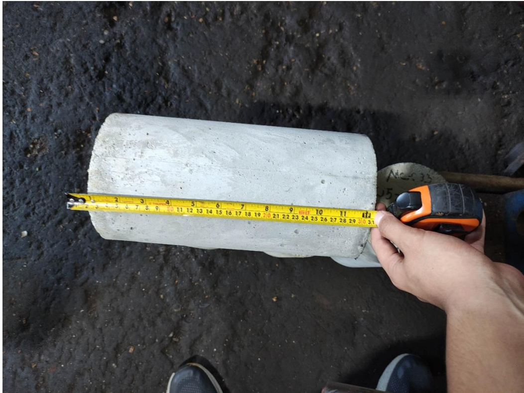
Figura A 4.3 Medición del largo de la probeta para el ensayo.
