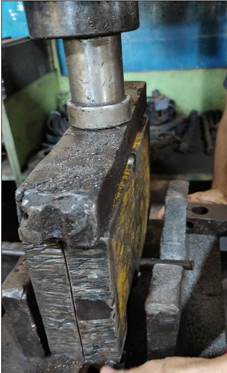
Figura 4.8 Colocación de probeta de acero en el montaje de corte doble.
