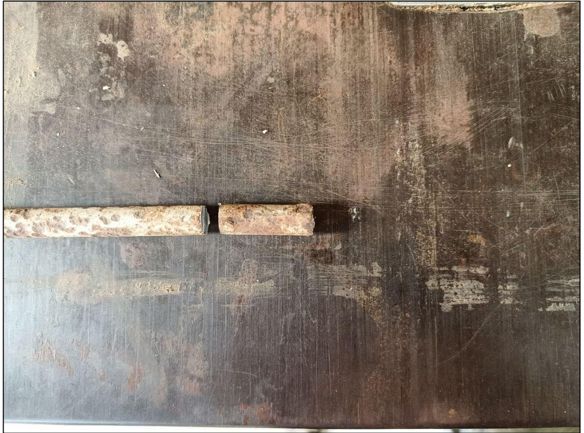
4.7 Probeta de acero en corte simple (Rotura).
