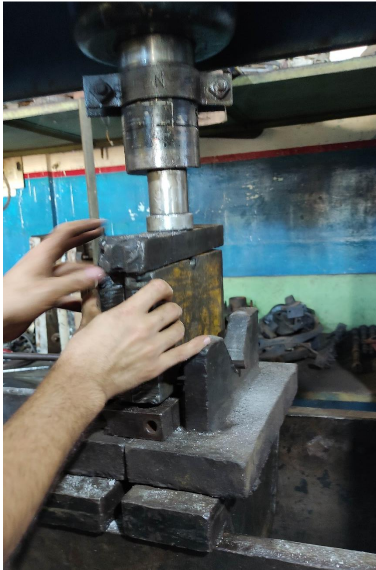
Figura A 3.1 Colocación de probeta en el montaje para ensayo de corte doble.
