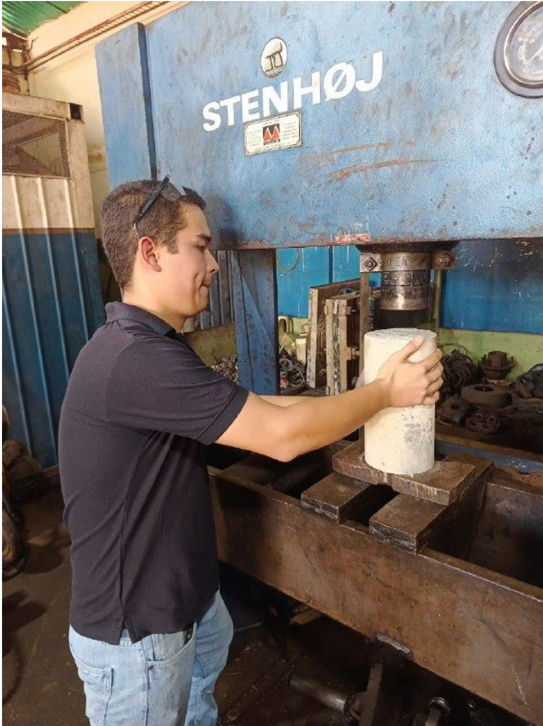
Figura A 4.4 Montaje de la probeta de concreto en la prensa hidráulica.
