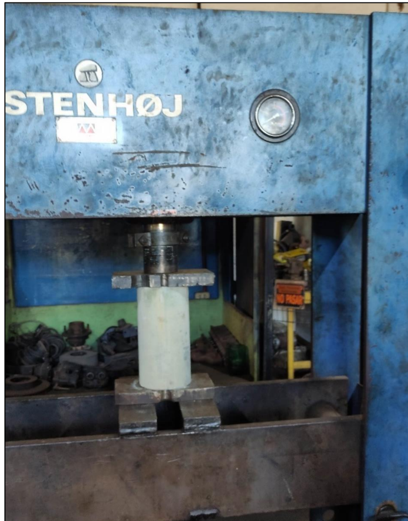
Figura 4.3 Colocación de probeta en la prensa hidráulica.
