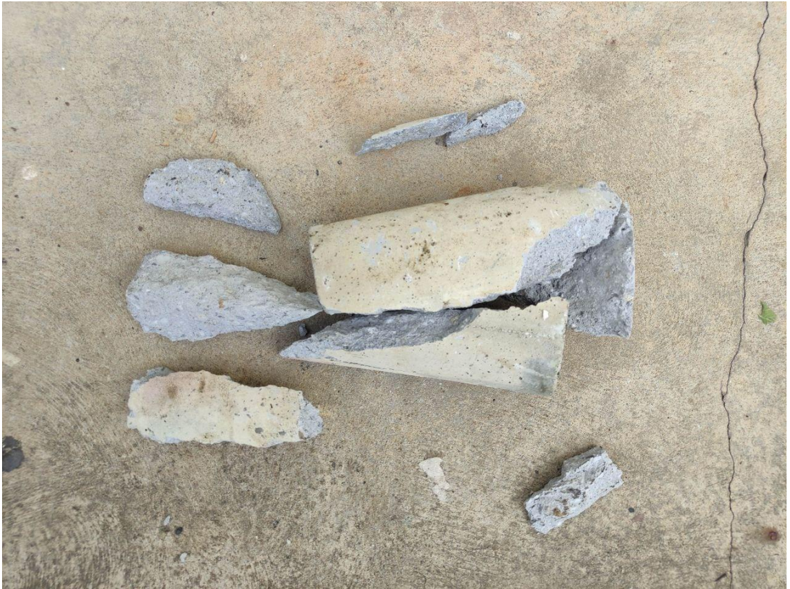
Figura A 4.6 Probeta de concreto fracturada.
