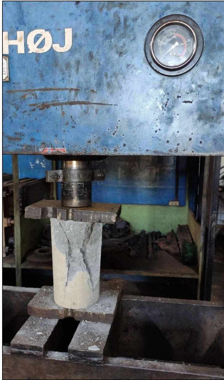
Figura 4.4 Alcance del esfuerzo último (Rotura).
