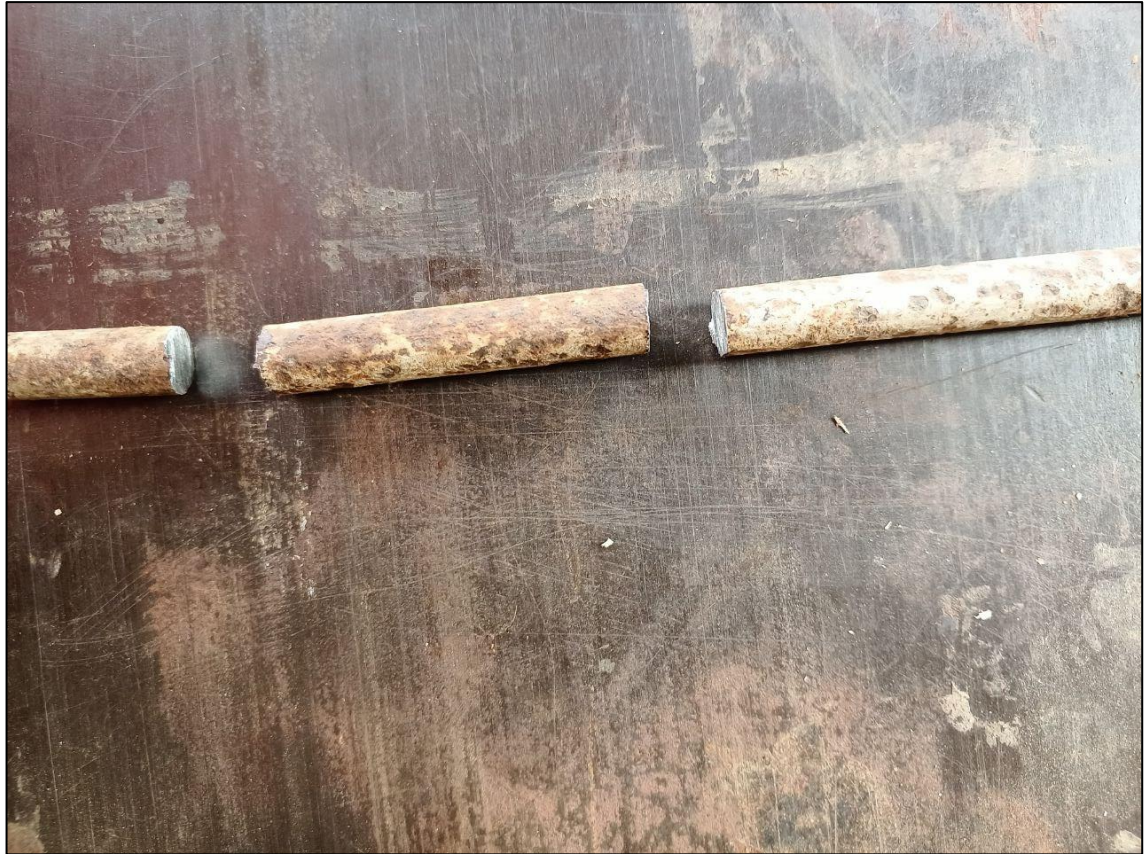
Figura 4.9. Probeta de acero en corte doble (Rotura).
