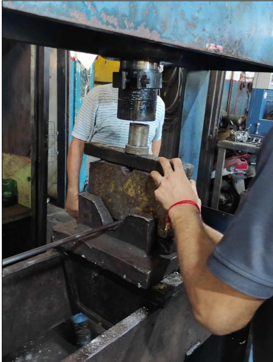
Figura 4.6. Colocación de probeta de acero en el montaje del corte simple.
