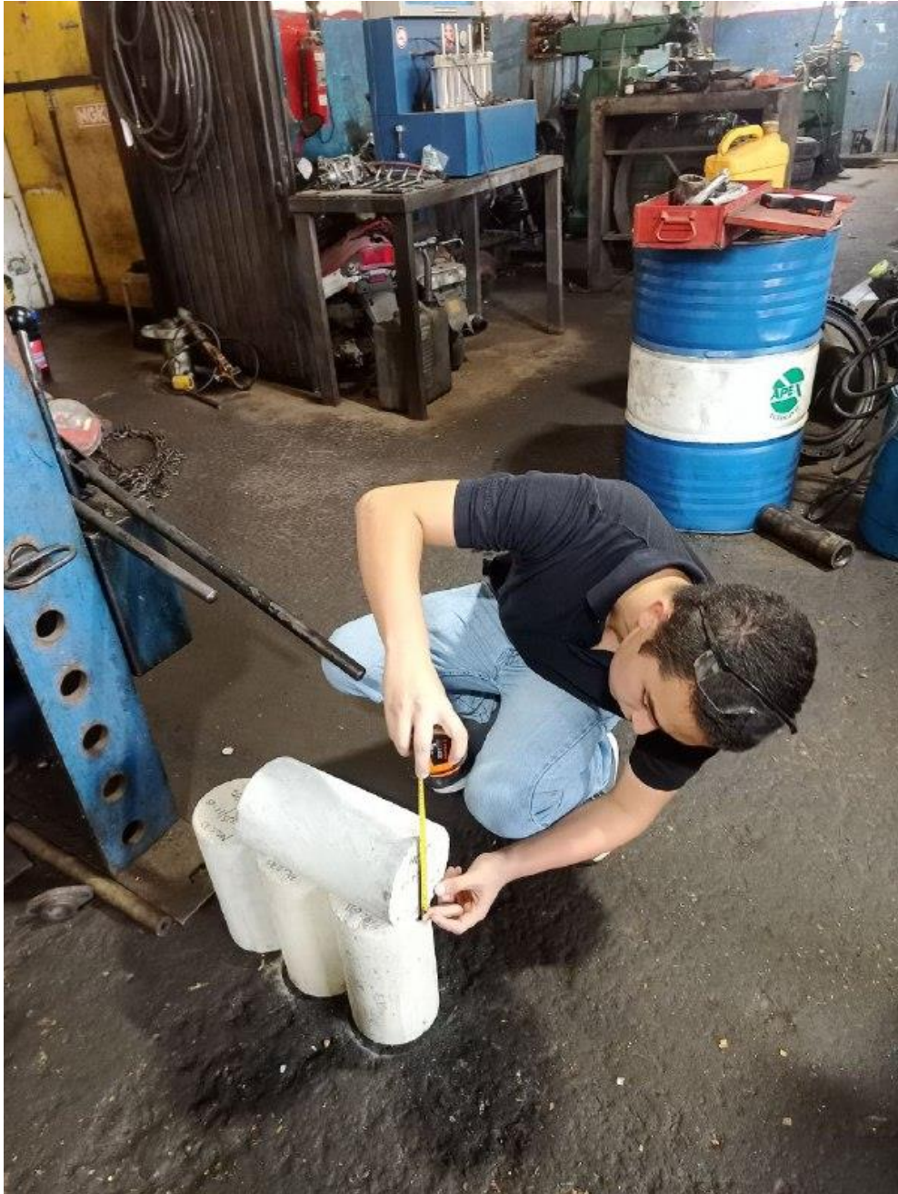
Figura A 4.2 Medición de probetas de concreto para el ensayo.
