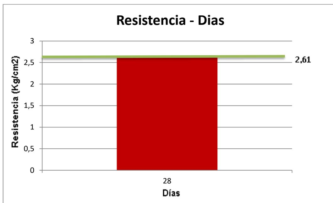
Gráfico 9. Resistencia vs Días del ladrillo de la mezcla #01.
