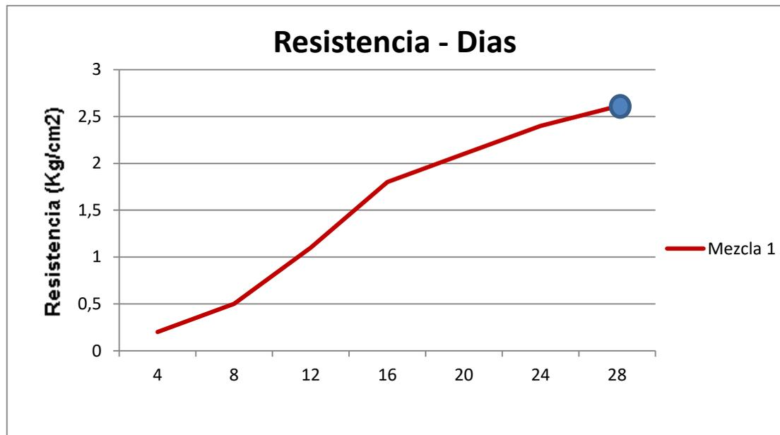
Gráfico 8. Resistencia vs Días del ladrillo de la mezcla #01.
