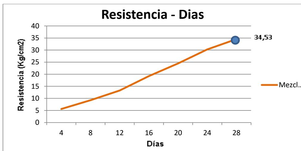
Gráfico 10. Resistencia vs Días del ladrillo de la mezcla #02.
