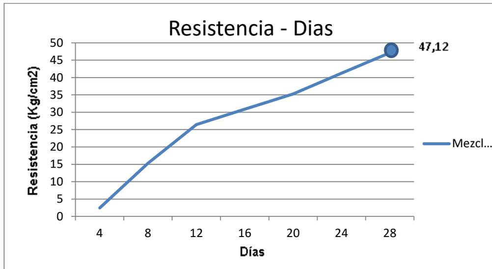
**Gráfico 12. Esfuerzo vs Días del ladrillo de la mezcla #03.**
