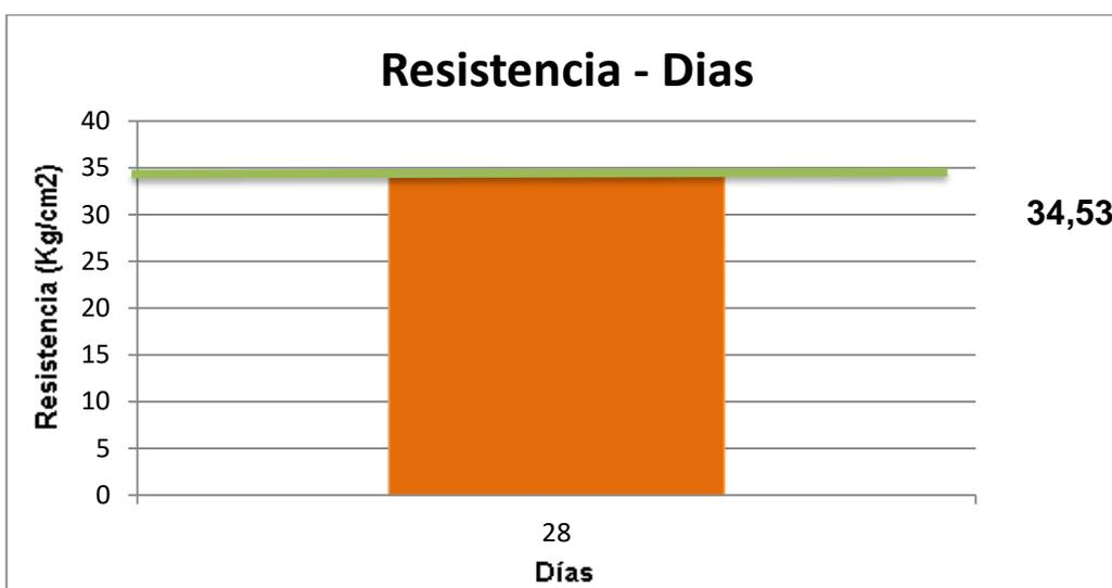
Gráfico 11. Resistencia vs Días del ladrillo de la mezcla #02.
