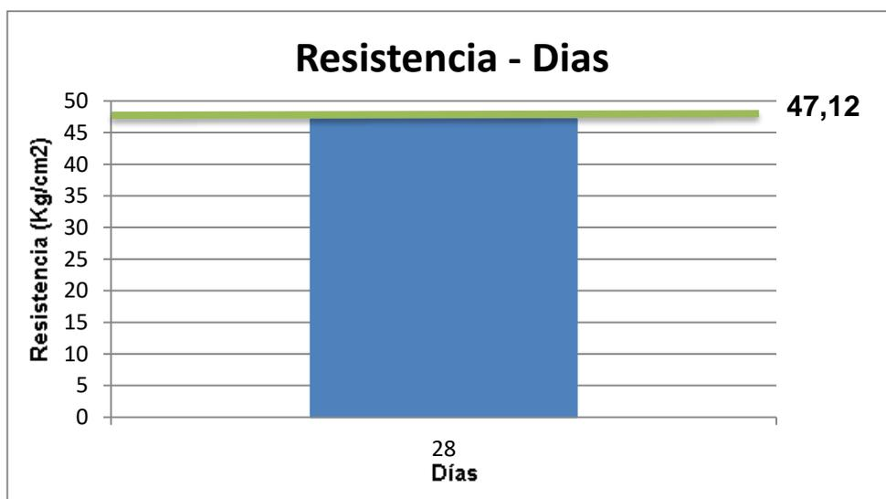
**Gráfico 13. Resistencia vs Días del ladrillo de la mezcla #03.**
