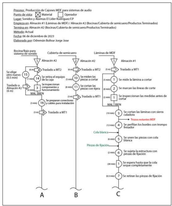
Figura 5.3 Diagrama de flujo de proceso actual de fabricación de cajones de sonido e instalación de complementos. (Elaboración propia, 2023)
