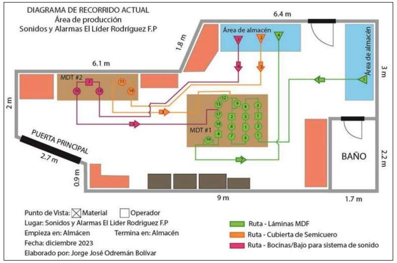
Figura 5.5 Diagrama de recorrido del proceso actual. (Elaboración propia, 2023)
