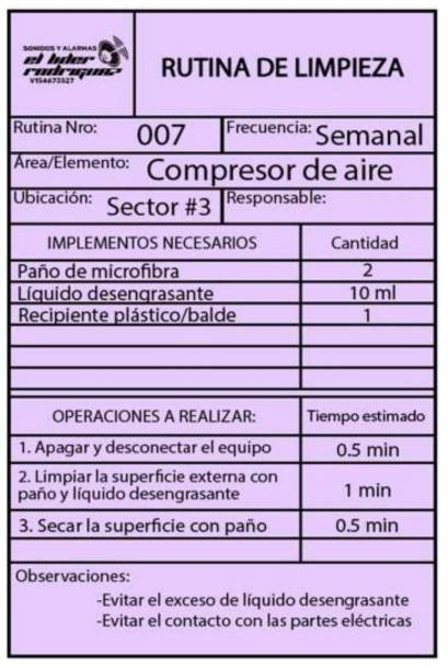
Figura D.7 Tarjeta de rutina de limpieza del compresor de aire. (Elaboración propia, 2024)
