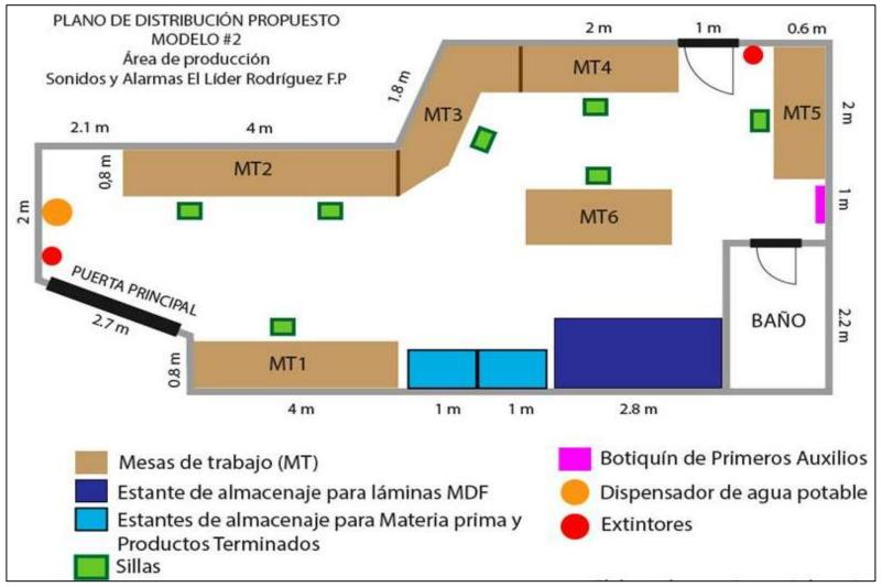
Figura 6.5 Alternativa modelo #2 de la distribución en planta propuesto. (Elaboración propia, 2024)
