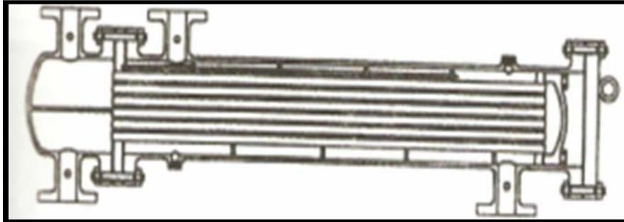
**Figura 2.8 Un intercambiador de calor semejante al de la figura excepto que este esta diseñado con un cabezal flotante para acomodar la expansión térmica diferencial entre los tubos y la coraza.**
