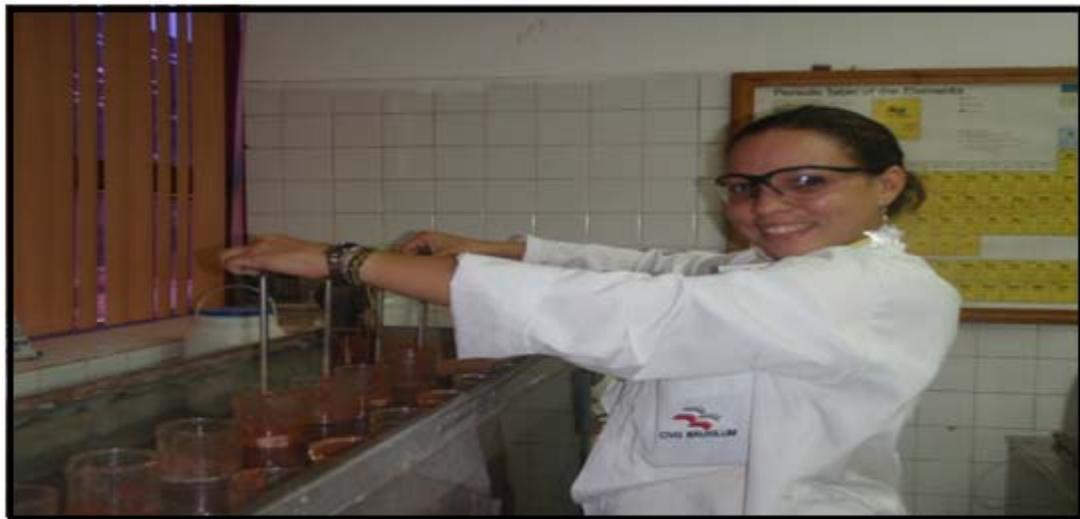
*Figura 3.3 Aplicación del método de la varilla perforada*
