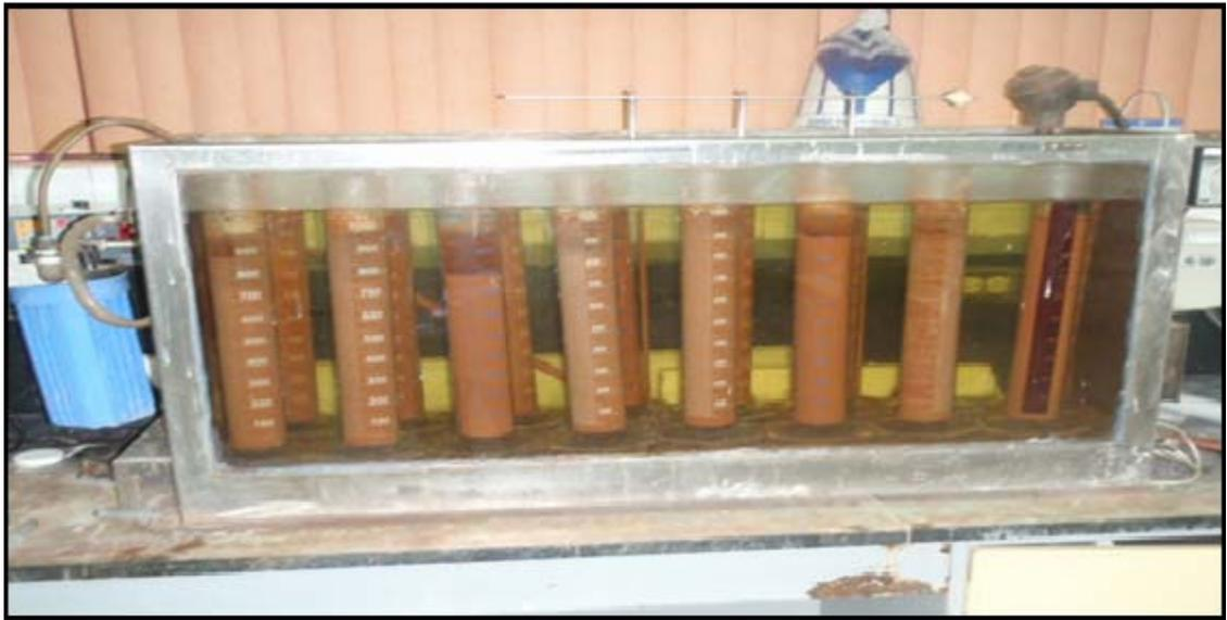
*Figura 3.2 Baño de calentamiento de sedimentación*
