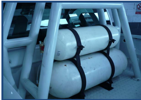
Figura 4.7. Cilindros de almacenamiento de GNV.
