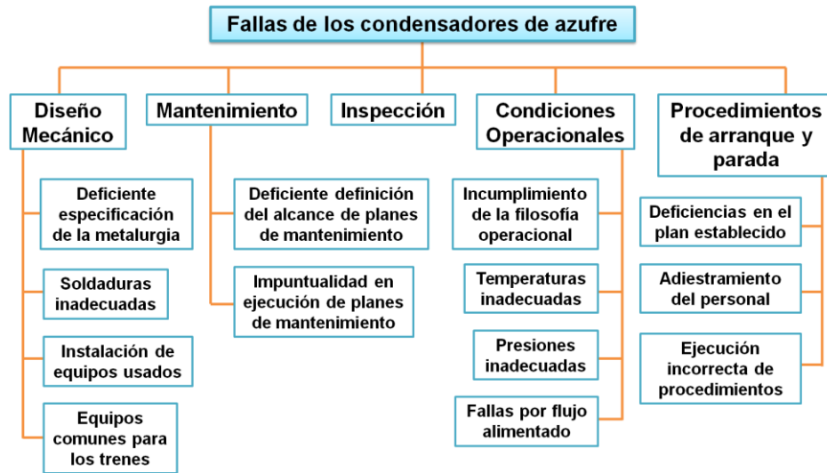
Figura 3.2 Árbol de fallas elaborado para la ejecución del análisis causa raíz
