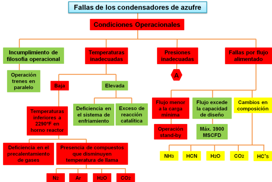
Figura 4.32 (b) Resultados del análisis causa raíz aplicado a las fallas de los condensadores del tren “I” de la unidad recuperadora de azufre
