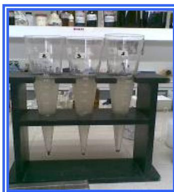
Figura 3.5 Medición de sólidos sedimentables
