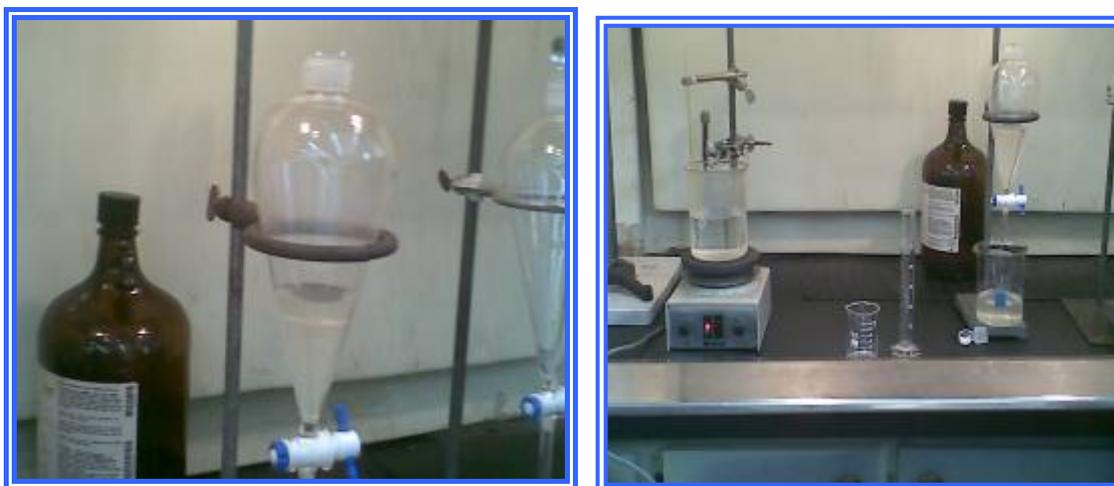
**Figura 3.10 Prueba para la determinación de aceites y grasas**
