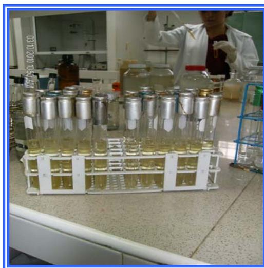
**Figura 4.32 Prueba de coliformes totales y fecales realizadas a la playa de Caño Salado**
