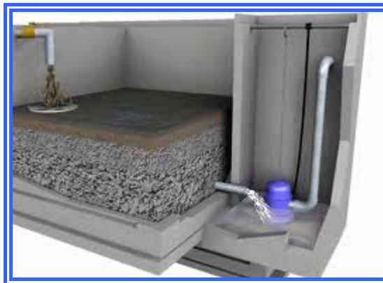
**Figura 2.5 Lechos filtrantes, tanque de filtrado**
