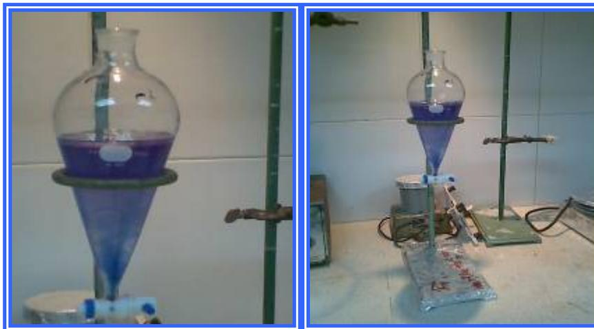
**Figura 3.11 Prueba para la determinación de detergentes**
