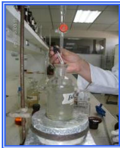
**Figura 3.7 Medición de oxígeno disuelto**
