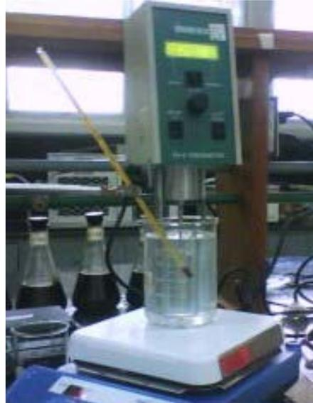
**Figura 3.2 Viscosímetro Brookfield, modelo LV.**
