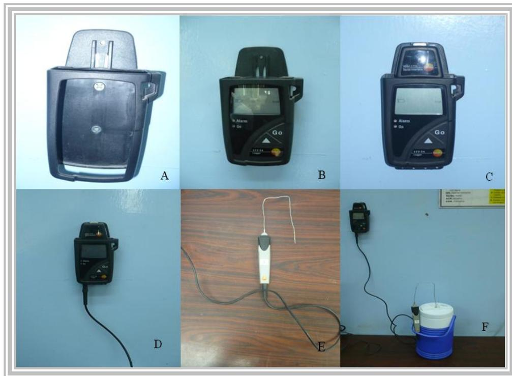
Figura 3.3. Conexión del sistema de medición en la cual, **A**; refleja la base del registrador fijada a la pared, **B**; la forma de colocar el registrador en el soporte, **C**; la conexión de la interface, **D**; la disposición de la termocupla en la parte inferior del
