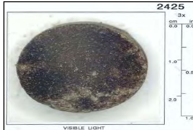
**Figura 3.1 Muestra de núcleo de pozo estratigráfico**
