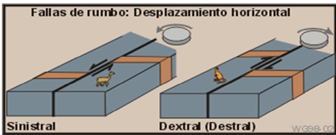
Figura 3.8 Fallas con desplazamiento horizontal (Wolfgang Griem, 2005).
