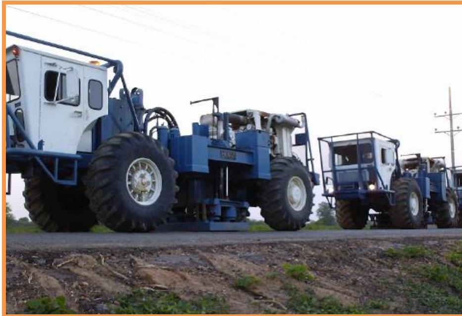
Figura 2.15: Camiones Vibradores. <sup>[11]</sup>
