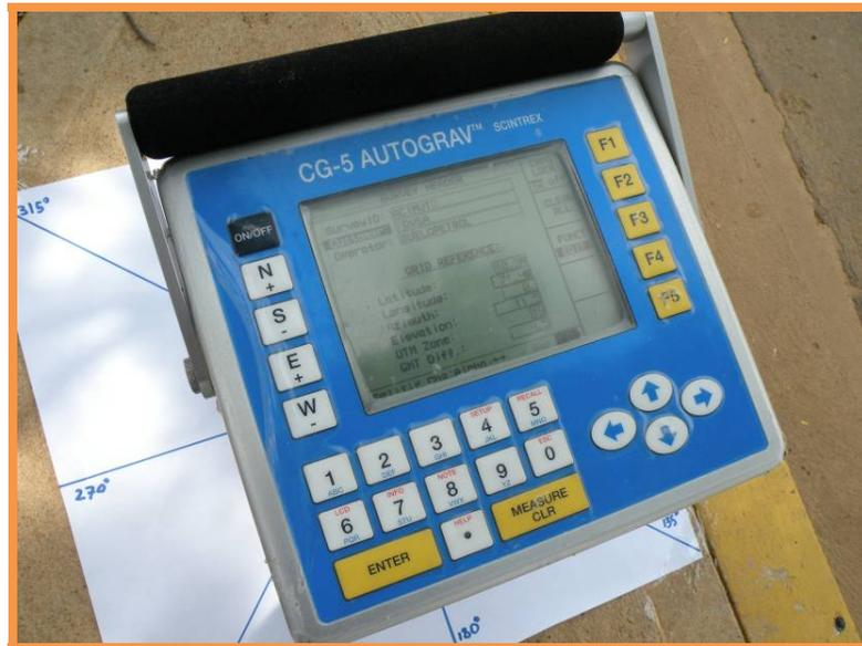
**Figura 3.2: Gravímetro Scintrex CG-5 Empleado en el Levantamiento.**
