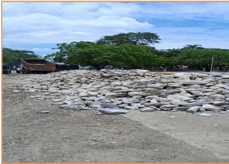
**Figura 3.5. Piedra bruta N4, producto de demolición de vía de concreto debajo del asfalto de la Av. 5 de Julio. Fuente: Autor (2023).**
