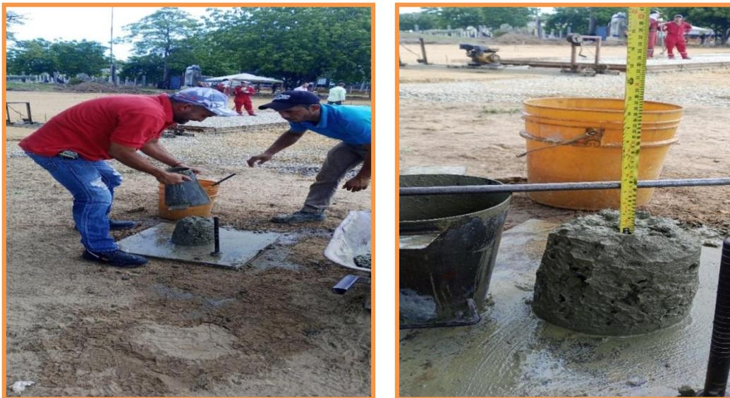
**Figura 3.17. Realización del cono de Abrams. Fuente: Autor (2023).**
