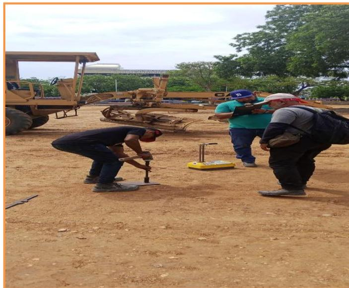
**Figura 3.13. Ensayos de laboratorio de compactación con densímetro nuclear. Fuente: El Autor (2023).**
